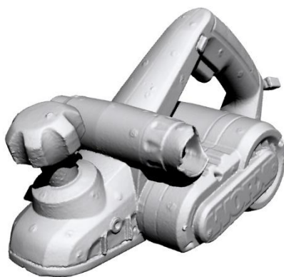
Obr. 5.20 Elektrický hoblík 3D sken – WORX (WX623.1).
