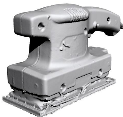
Obr. 5.32 Vibrační bruska 3D sken - _ (PTSS 150).
