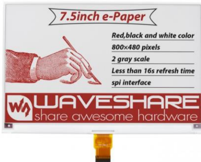
Obrázek 9: Použitá komponenta – 7,5–palcový elektronický papír [1]
