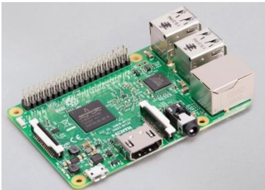
Obrázek 14: Raspberry Pi 3 Model B [12]
