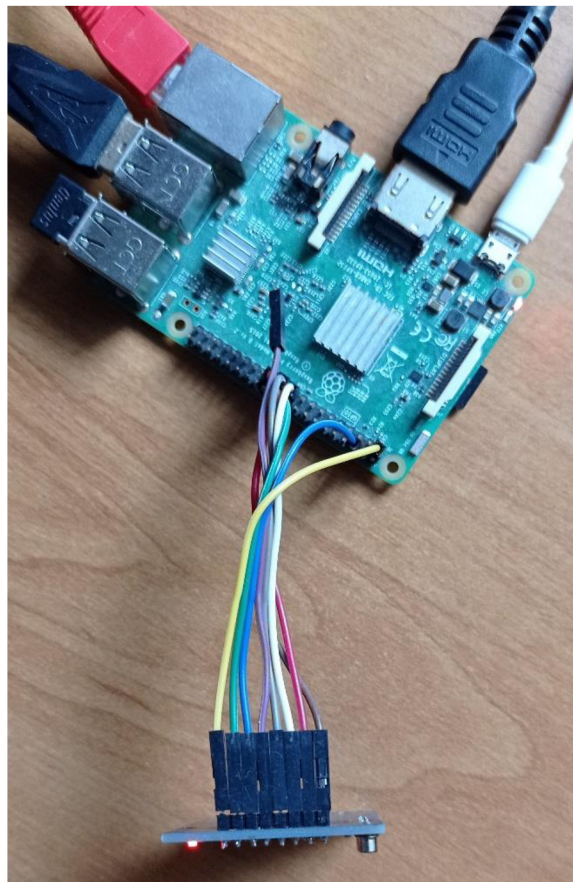
Obrázek 37: Nadřazený systém s RFID čtečkou
