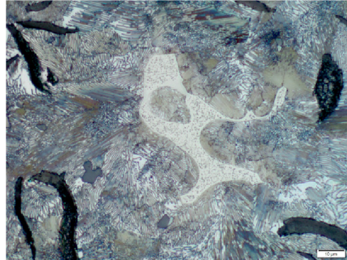
Obr. 1.9: Mikrostruktura obsahující steadit
