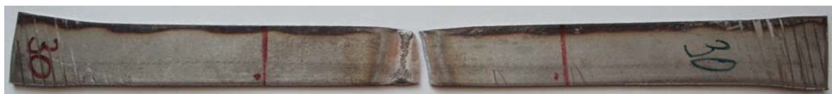
Obr. 36 Lom vzorku č.5
