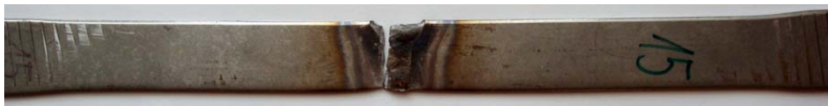
Obr. 27 Lom vzorku č.2
