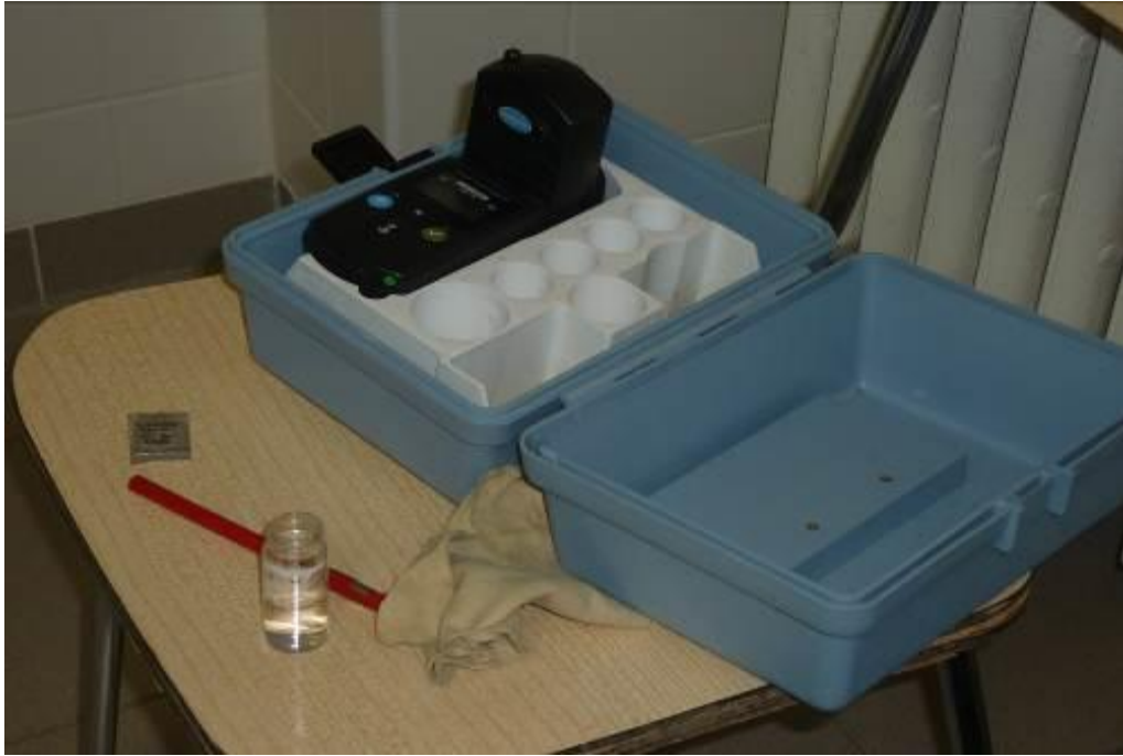
Obrázek č. 13. FOTOMETR HCHA pro měření koncentrace volného chlóru v pitné vodě (zdroj: autor).
