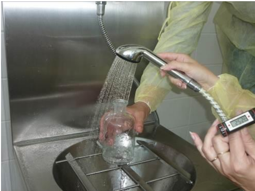
Obrázek č. 11. Odběr TUV do vzorkovnice (zdroj: autor).
