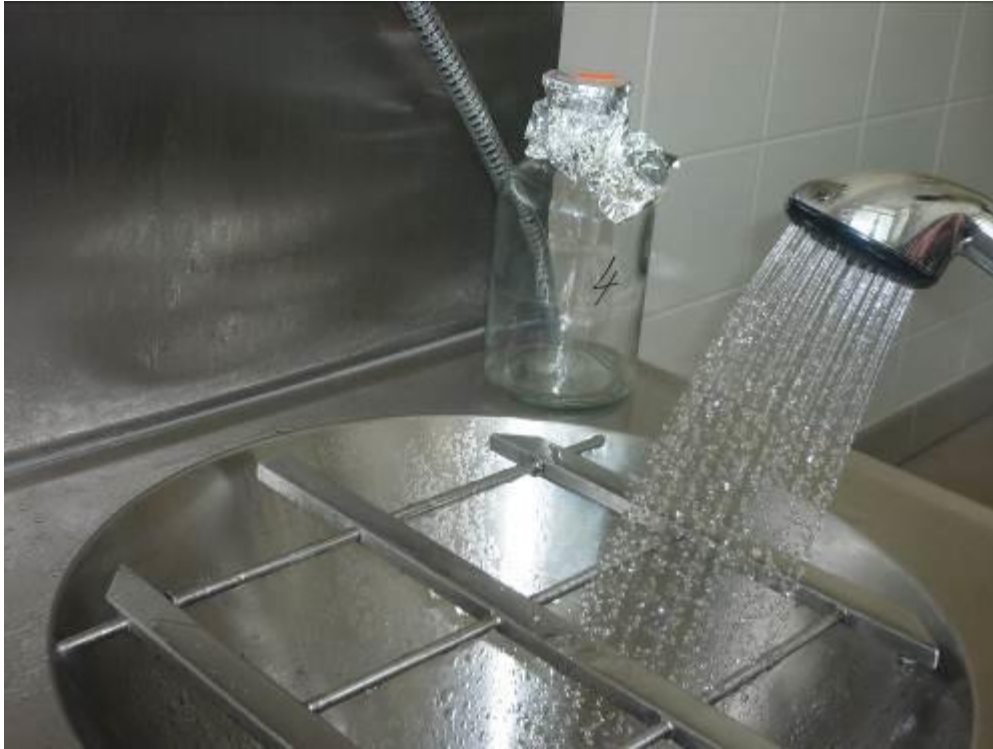
Obrázek č. 10. Odpuštění TUV před odběrem vzorku (zdroj: autor).
