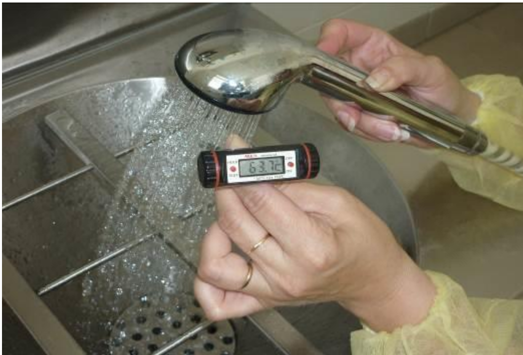
Obrázek č. 12. Měření teploty kontaktním digitálním teploměrem (zdroj: autor).
