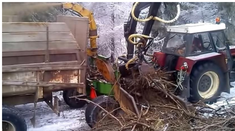
Obr. 43 Štěpkování do připraveného návěsu u linky č. 3 (Zdroj: Marek Maršál)
