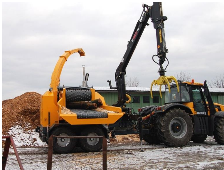
Obr. 21 Bubnový štěpkovač Jensen TJ 1250 (Zdroj: http://www.agrocar.cz/storage/photo/large/jensen_tj_7.jpg )
