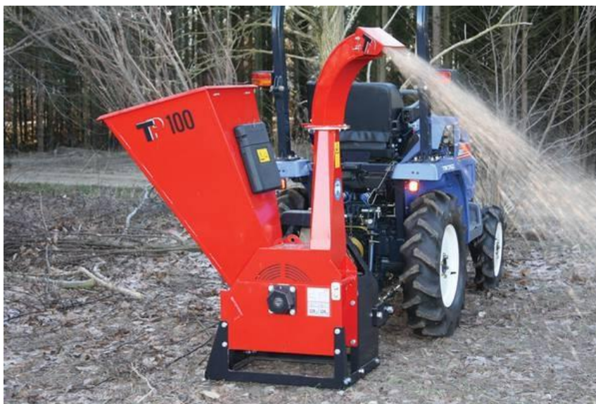
Obr. 23 Štěpkovač Linddana TP 100 ve verzi za traktor (Zdroj: http://www.forestmeri.cz/cms/upload/galerie/nahledy/1332510320.jpg )
