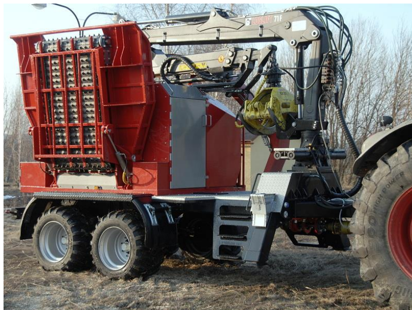
Obr. 17 Štěpkovač Maxim 1270 HR (Zdroj: http://www.stepkovace.cz/foto/Maxim1270_04f.jpg )
