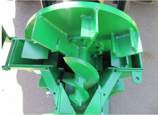
Obr. 9 Ukázka šnekového drtícího ústrojí (Zdroj: http://www.bystron.cz/obr/pirana/v/8.jpg?ver=12 )
