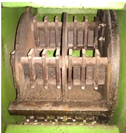
Obr. 12 Princip kladívkového drtící ústrojí u štěpkovače Laski KDO 90 T (Zdroj: vlastní)
