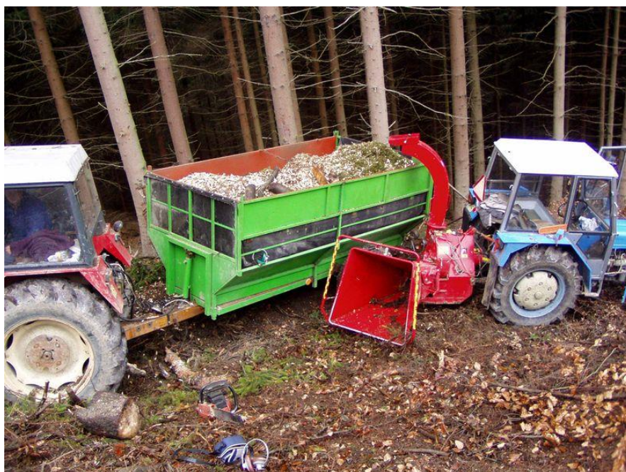
Obr. 42 Štěpkování do připraveného návěsu u linky č. 2 (Zdroj: Josef Janečka)
