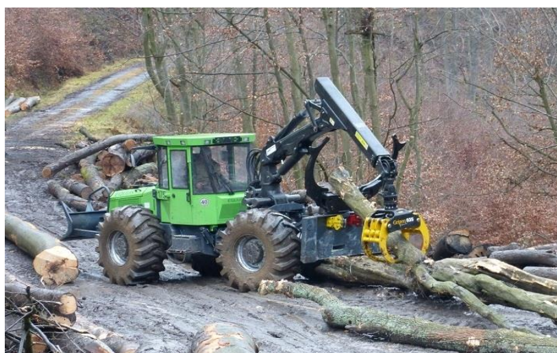
Obr. 27 SLKT značky Equus 175N se svěrným oplénem (Zdroj: http://www.forestmeri.cz/cms/upload/galerie/obrazky/1423417345.jpg )
