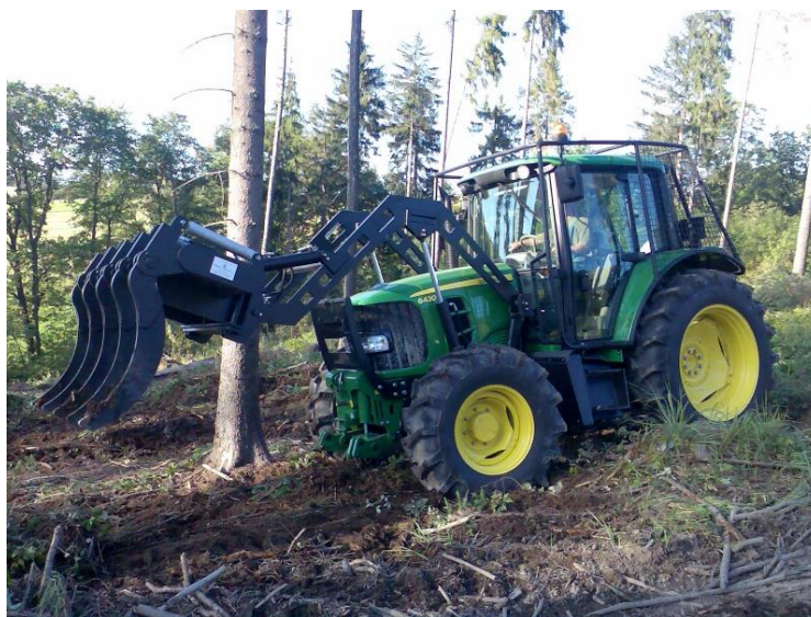
Obr. 30 Shrnovač klestu na UKT značky John Deere (Zdroj: http://www.forestmeri.cz/cms/upload/galerie/obrazky/1331314387.jpg )
