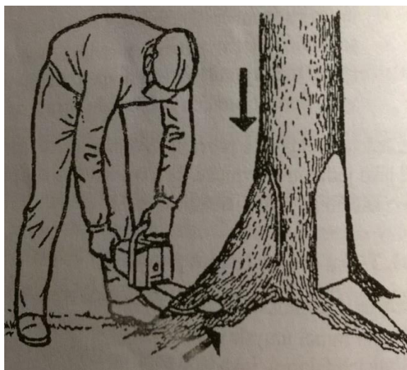
Obr. 25 Odřezávání kořenových náběhů
