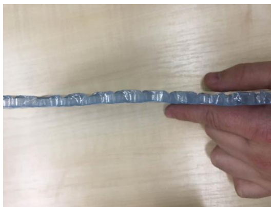
Obr. 10 Typický příklad reflexní izolace typu 1, bublinková folie [autor]
