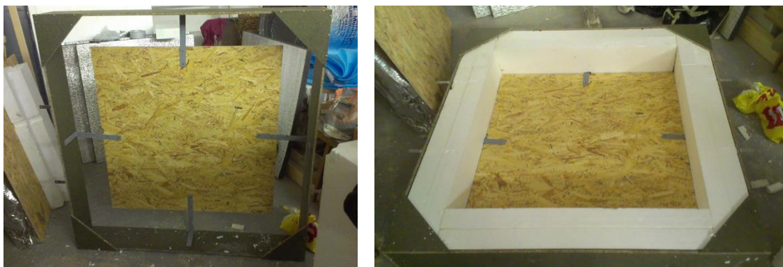
Obr. 21 Ukázka z realizace typického zkušební prvku pro měření tepelného odporu izolované vzduchové dutiny [autor]
