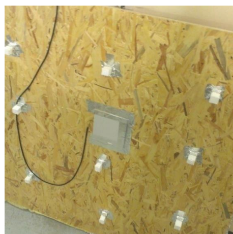
Obr. 36 Pohled na měřicí ústřednu - datalogger univerzální ALMEMO 2890-9 a osazení měřicího čidla - snímače tepelného toku a povrchové teploty [archiv autora]
