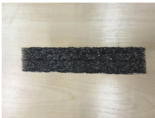
Obr. 8 Typický příklad reflexní izolace typu 1, jádro z pěnového polyetylénu [autor]
