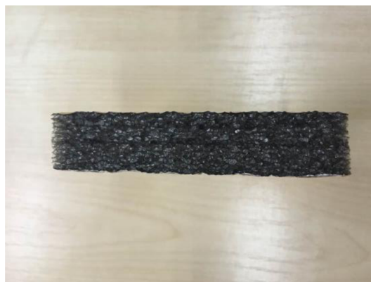
Obr. 8 Typický příklad reflexní izolace typu 1, jádro z pěnového polyetylénu [autor]
