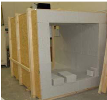
Obr. 18 Pohled na chladicí box [archiv autora] (nahrazení zařízení s kalibrovanou teplou skříní dle ČSN EN ISO 8990)
