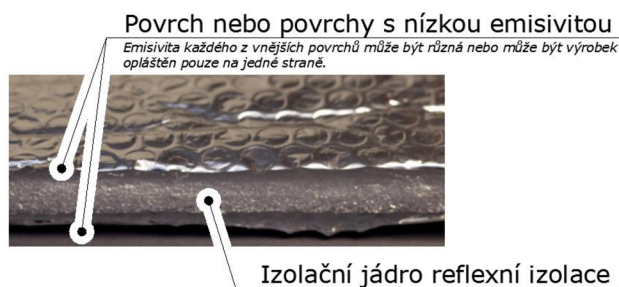
Obr. 7 Schéma složení reflexní izolace [autor, dle ČSN EN 16012]
