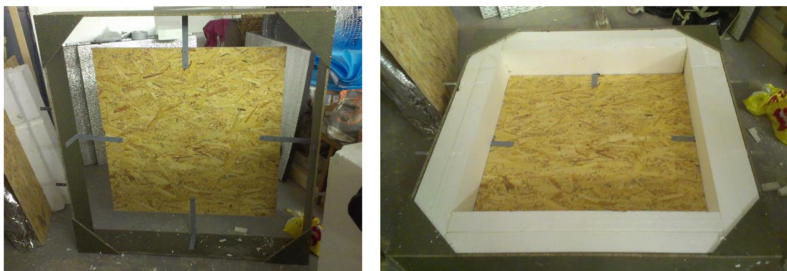
Obr. 21 Ukázka z realizace typického zkušební prvku pro měření tepelného odporu izolované vzduchové dutiny [autor]
