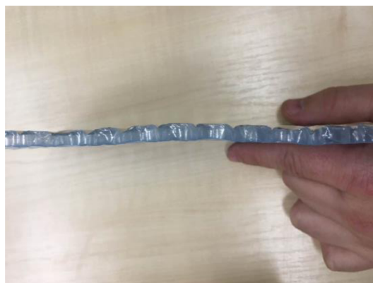
Obr. 10 Typický příklad reflexní izolace typu 1, bublinková folie [autor]
