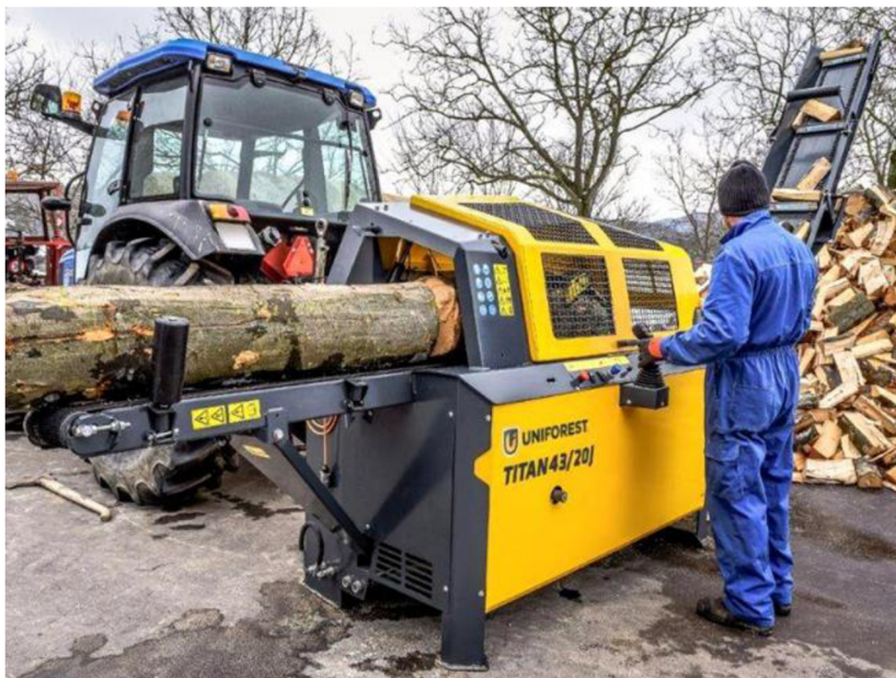
Obr. 4 Štípací automat Uniforest Titan42/20J [1]
