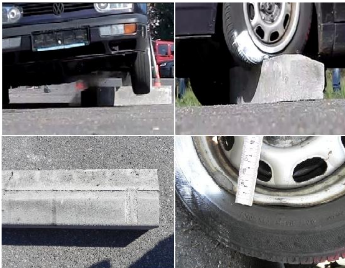
Obrázek 22: vzniklé poškození po najetí na obrubník
