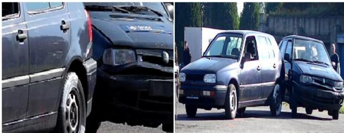
Obrázek 26: náraz vozidla do plastového nárazníku
