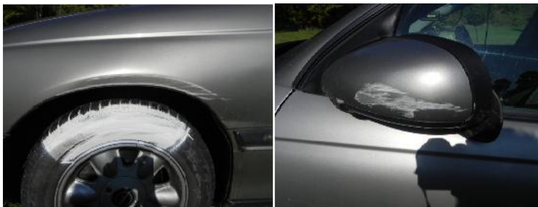
Obrázek 25: vzniklé poškození po kontaktu s betonovým sloupkem
