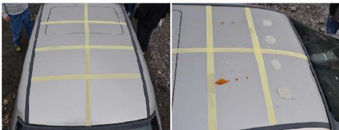
Obrázek 16: působení agresivní látky na lak karoserie vozidla
