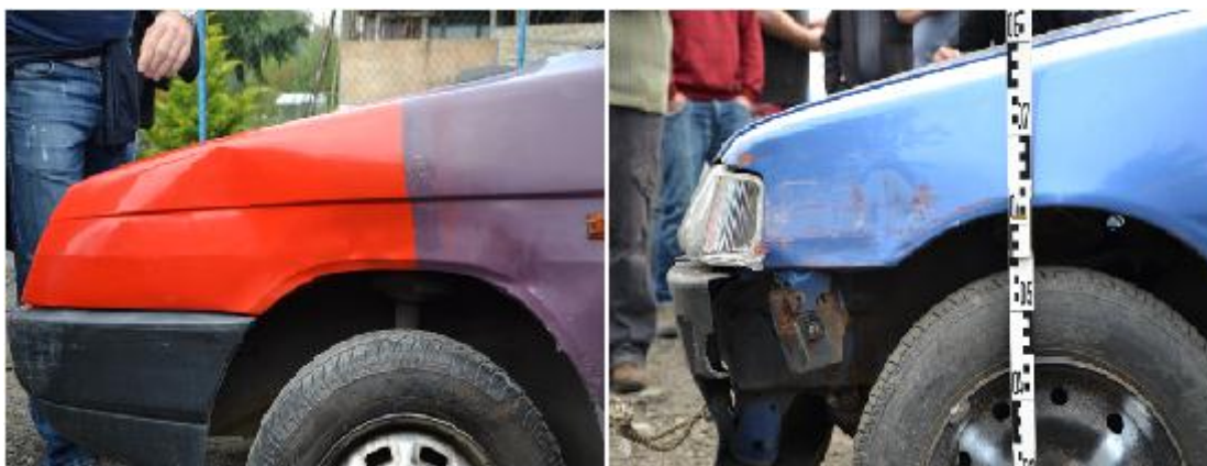
Obrázek 15: výsledné poškození blatníků po vzájemném kontaktu
