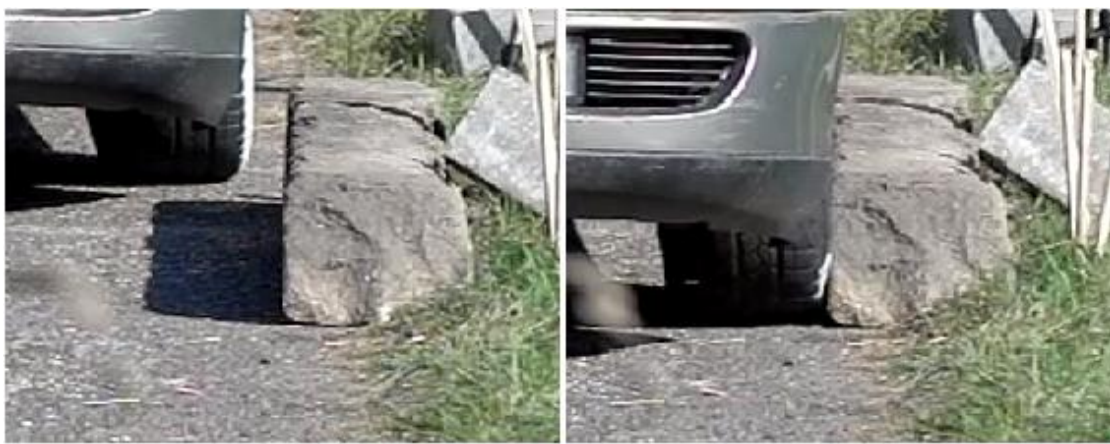
Obrázek 18: poškození disku kola vozidla o obrubník
