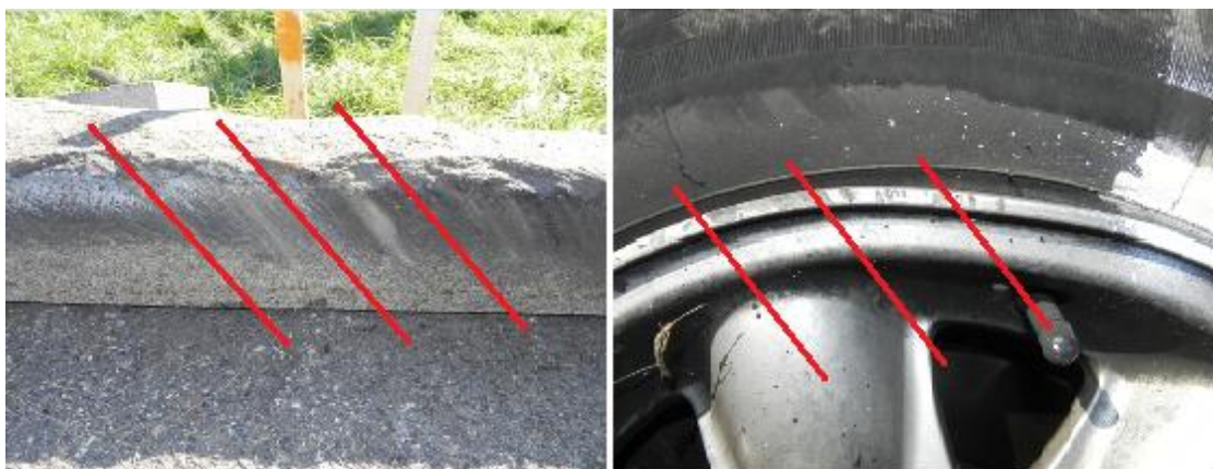
Obrázek 19: rozsah vzniklého poškození po vzájemném kontaktu disku kola s obrubníkem
