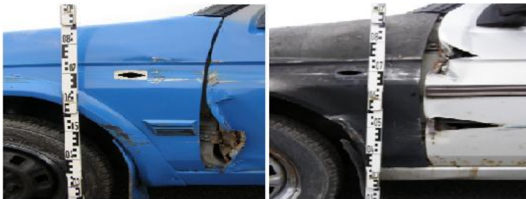
Obrázek 7: náraz do svodidel v protisměru
