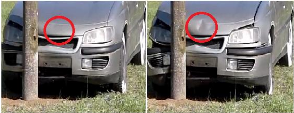
Obrázek 20: deformace kapoty v průběhu nárazu do pevné překážky
