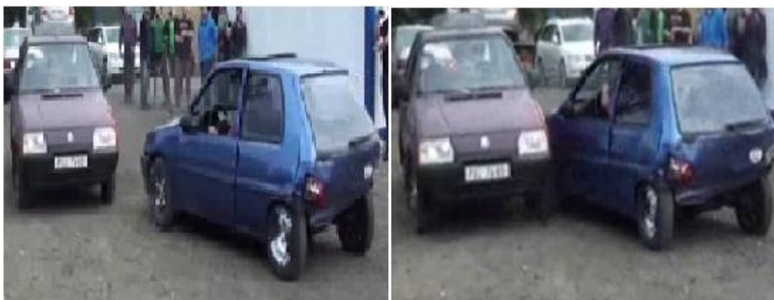
Obrázek 14: náraz vozidla pro posouzení vzniklé deformace blatníku
