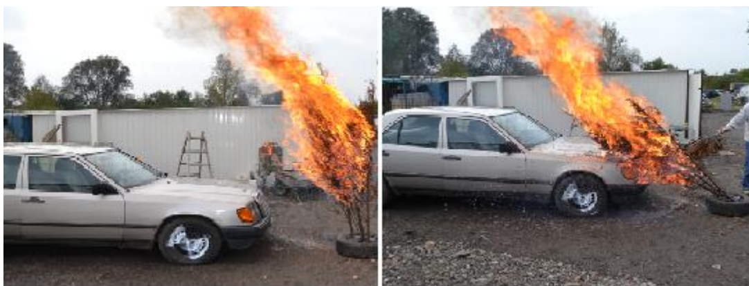
Obrázek 12: poškození laku karoserie vozidla plamenem
