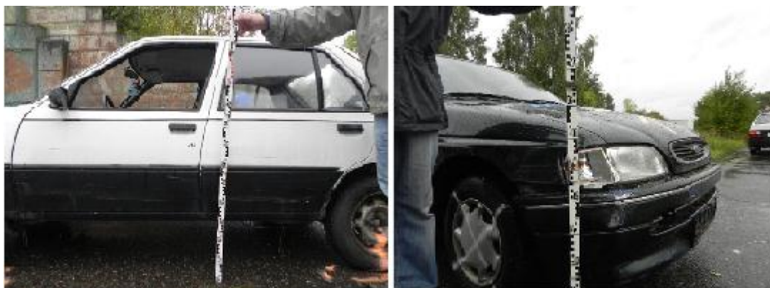
Obrázek 2: vzniklé poškození na vozidlech po provedeném testu
