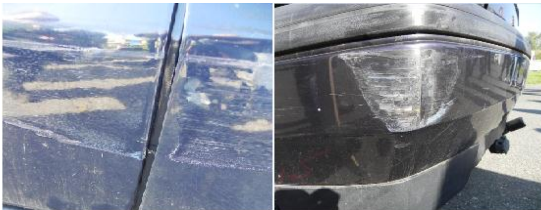
Obrázek 27: vzniklé poškození vozidla po kontaktu s plastovým nárazníkem
