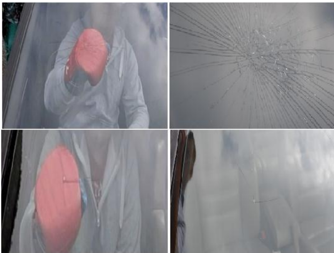
Obrázek 11: poškození čelního skla z vnitřní strany, nahoře bez vady skla, dole s poškozením od kamene
