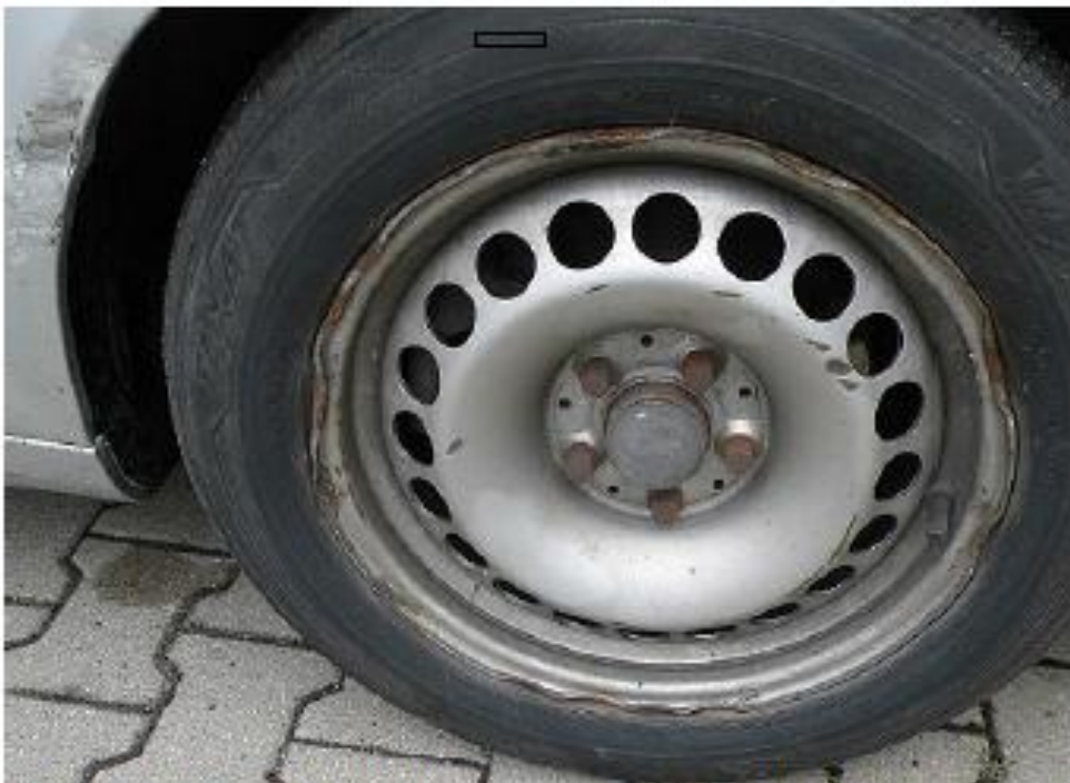
Obr. 11: Minimálně 16 důlkovitých záseků na obvodu disku PP kola zanechávaly šrouby pro spojování svodidel s pákulatou hlavou při opakovaných nájezdech na svodidla nejen při této škodní události, ale dle rozdílné koroze na def. místech i dříve
