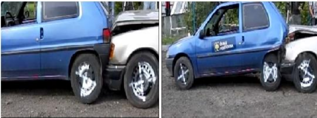
Obrázek 8: překrytí původního poškození způsobené vyšší rychlosti nárazu
