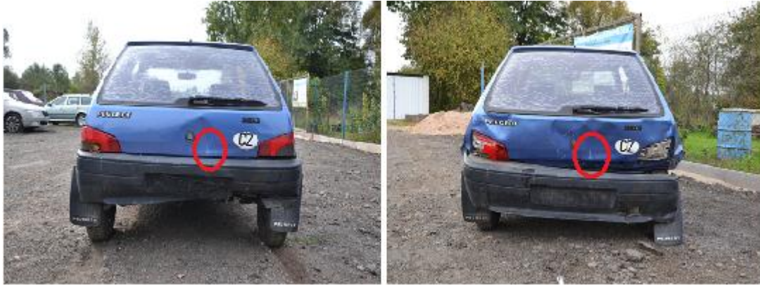
Obrázek 9: výsledné poškození vozidla po nárazu rozdílnou rychlostí
