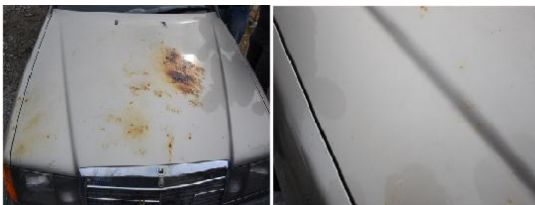
Obrázek 13: vzniklé poškození od plamene
