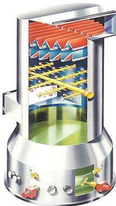
Obr. 4.4 Absorbér pro mokré odsíření spalin [90].
