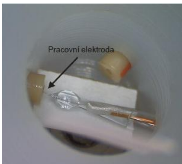
Obr. 14: Fotografie elektrochemické detekční cely při dvouelektrodovém zapojení s pracovní elektrodou CFME, 5x zvětšeno, strana fotografie odpovídá ve skutečnosti asi 1,5 cm, převzato z [73]
