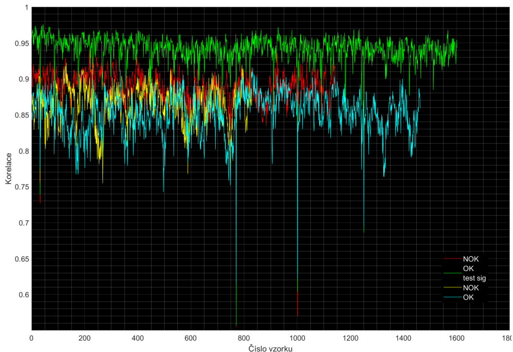
Obr. 33: Graf frekvenční korelace průměru bufferu FIFO s následujícím úderem
