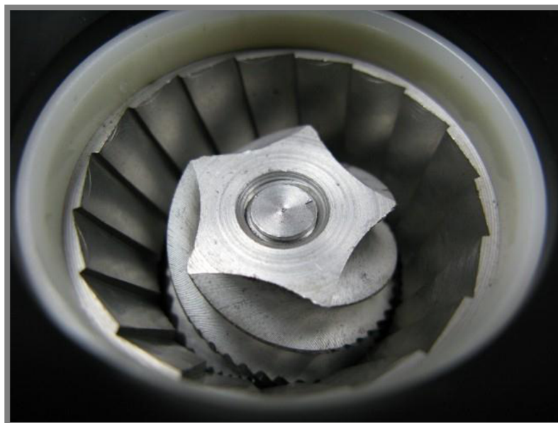
Obr. 2-1 Ocelové konické mlecí kameny
