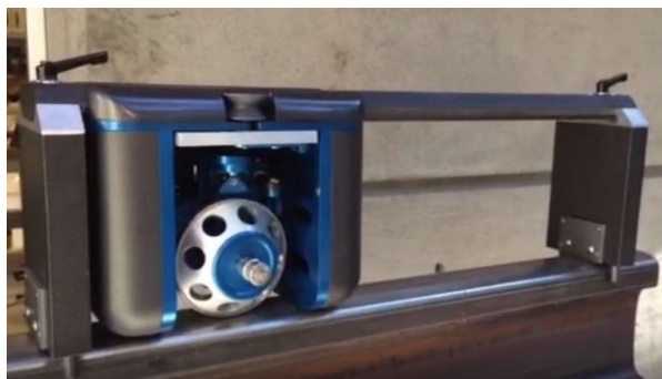
obr. 2-10 Automatický přenosný tribometr [17]
