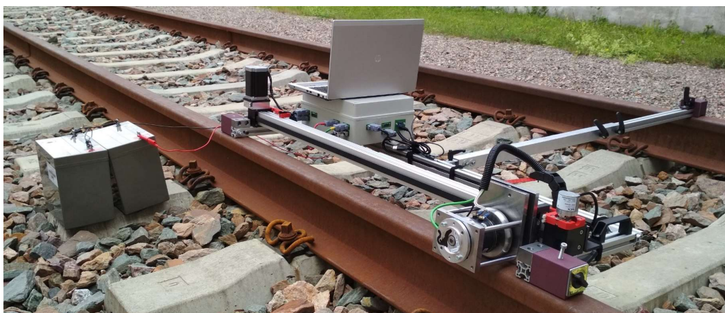
obr. 5-42 Tribometr na širokopatních kolejnicích
