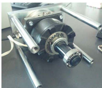
obr. 5-26 Elektromagnetická brzda uložená v měřicím modulu
