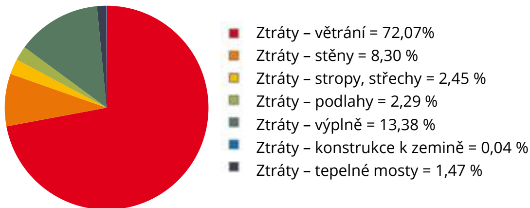
Graf 2 tepelné ztráty a zisky prostupem konstrukcí a větráním pro hodnocenou budovu - nový stav
