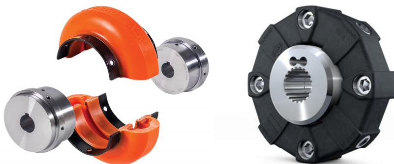
Obr. 11 Elastomerní spojka přenášející točivý moment ve smyku (vlevo) [23] Elastomerní spojka přenášející točivý moment při kompresi (vpravo) [17]
