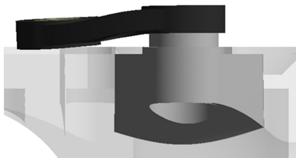
Obr. 40 Mezera mezi segmentem a unašečem po úpravě návrhu
