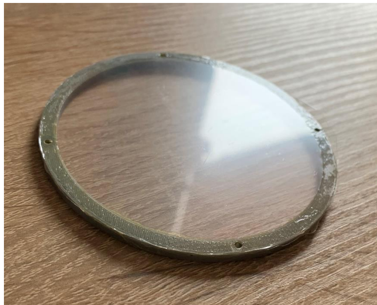
Obr. 4.3 Napnutá a přilepená membrána
