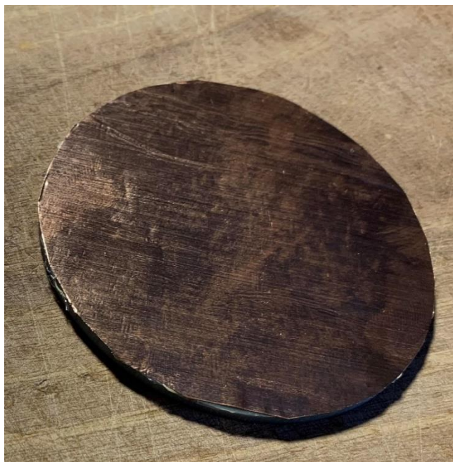
Obr. 4.4 Membrána s nalepenou vrstvou mědi
