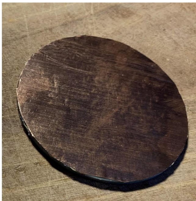
Obr. 4.4 Membrána s nalepenou vrstvou mědi
