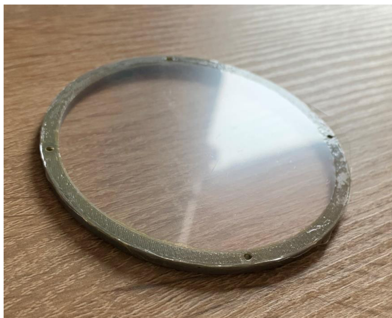
Obr. 4.3 Napnutá a přilepená membrána
