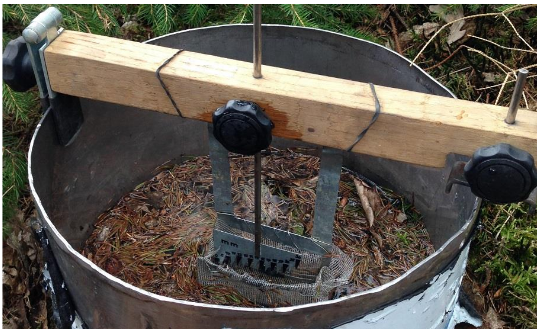
Obr. č. 16 - na závěr měření infiltrace je potřeba změřit průměrnou hloubku výtopy ve válci. (Redl, 2016).
