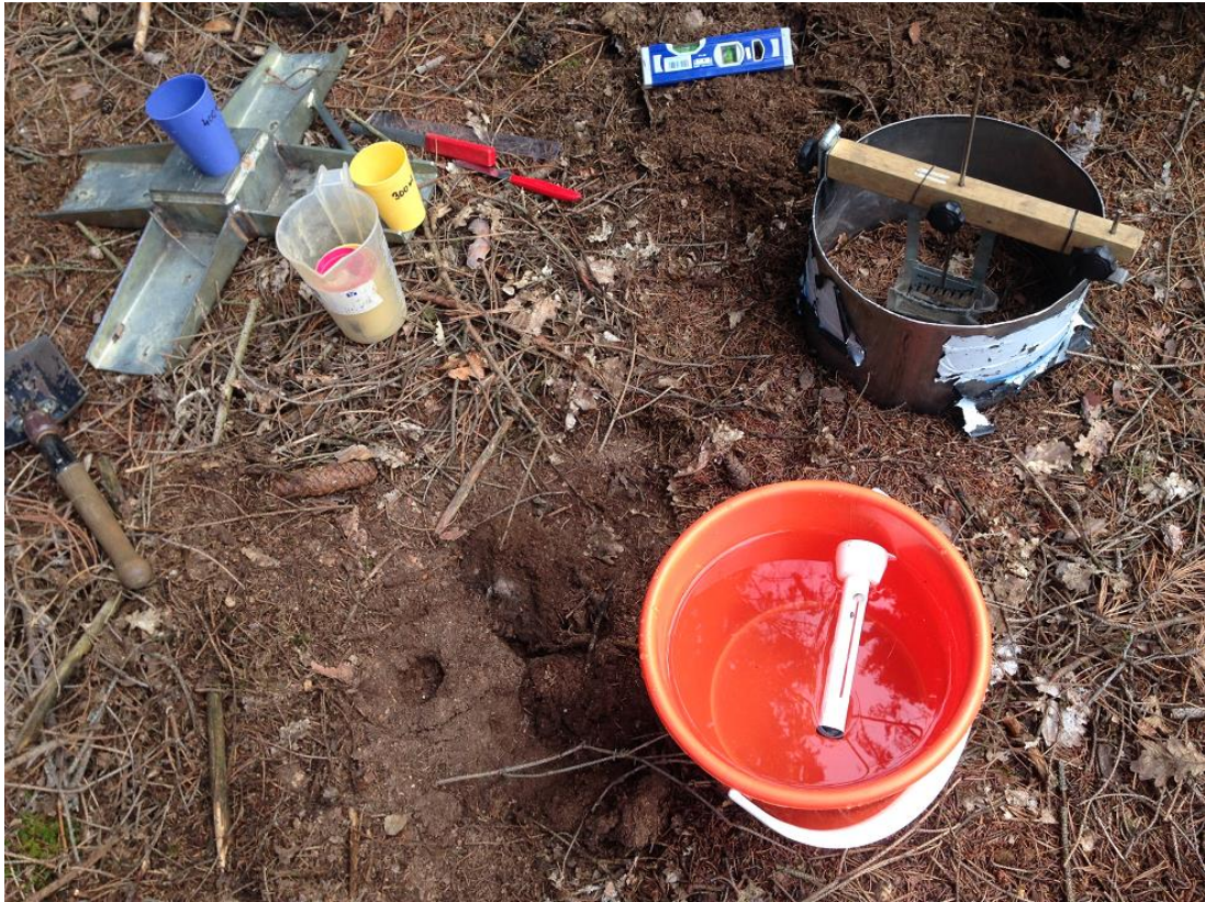
Obr. č. 32 - před započítím infiltrace na nezhutněném povrchu. (Redl, 2016).
