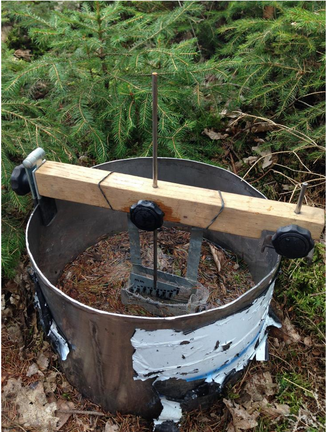
Obr. č. 36 - infiltrace na nezhutněném povrchu. (Redl, 2016).
