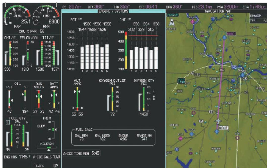
Obr.č.21-MFD zobrazujúci informácie o motore a príslušných systémoch a navigačnú mapu[37]
