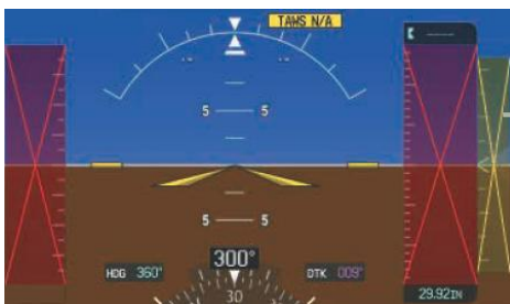
Obr.č.22 - príklad indikácie nefunkčnosti daného letového prístroja na PFD[37]
