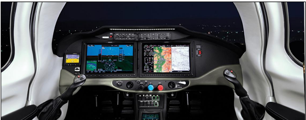
Obr.č.18 - cockpit vybavený systémom Garmin G2000[36]
