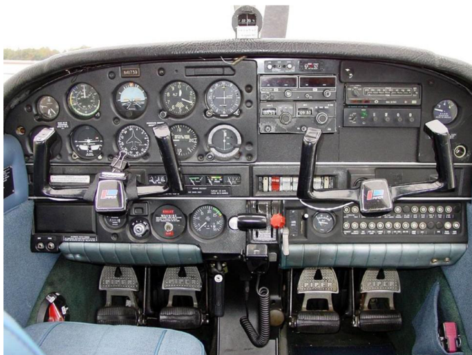
Obr.č.27 – Prístrojové vybavenie PA28-151
