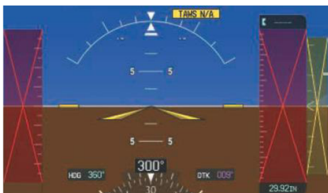
Obr.č.22 - príklad indikácie nefunkčnosti daného letového prístroja na PFD[37]
