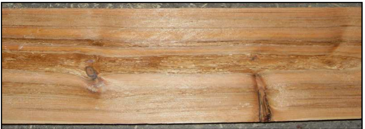
Obrázek 6 - Měkká hniloba, borovice
