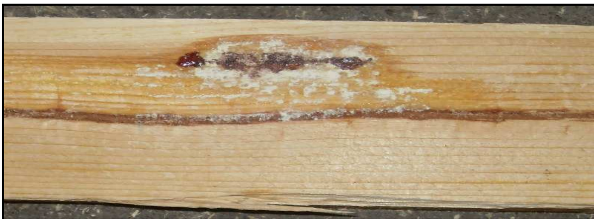
Obrázek 5 – Příklady heterogenity borovicového řeziva – dřeň, smolník, prosmol
