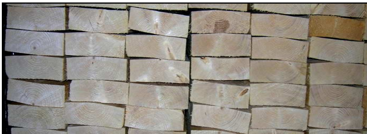
Obrázek 8 - Příčné borcení sortimentů v důsledku anizotropního sesychání dřeva
