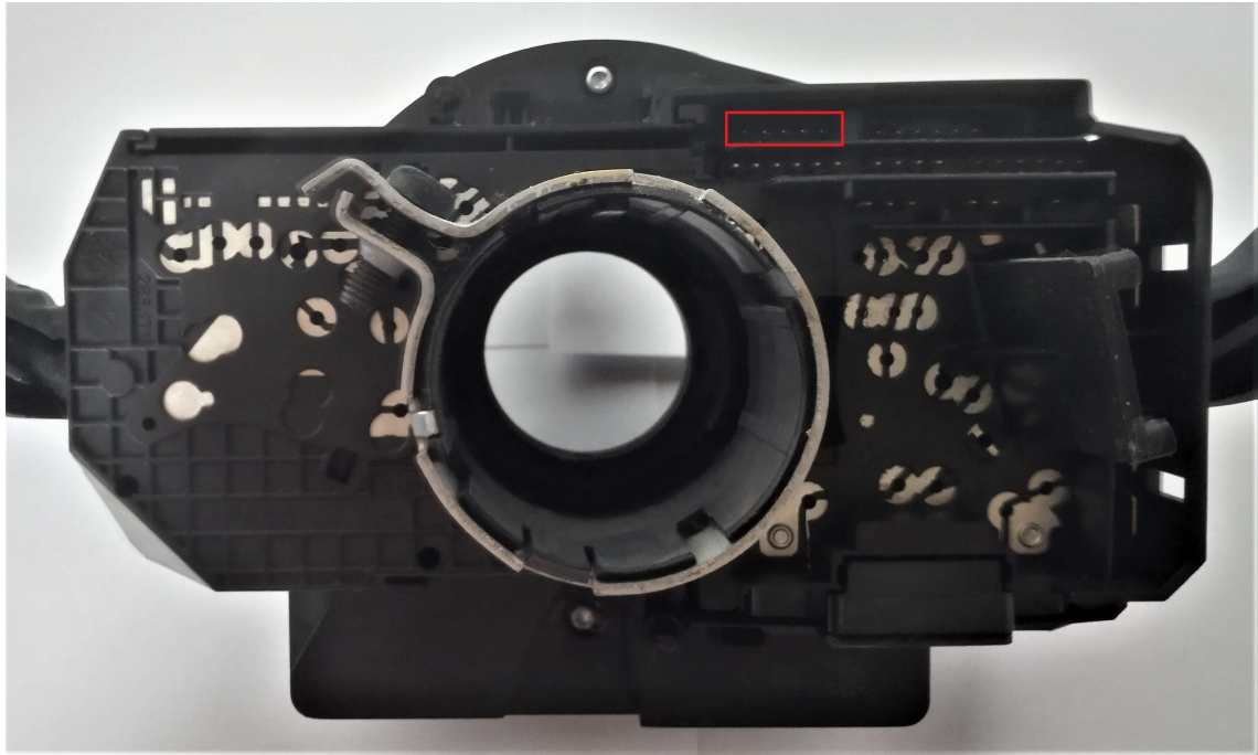
Obrázek 4.8: Zadní strana podvolantové jednotky.
