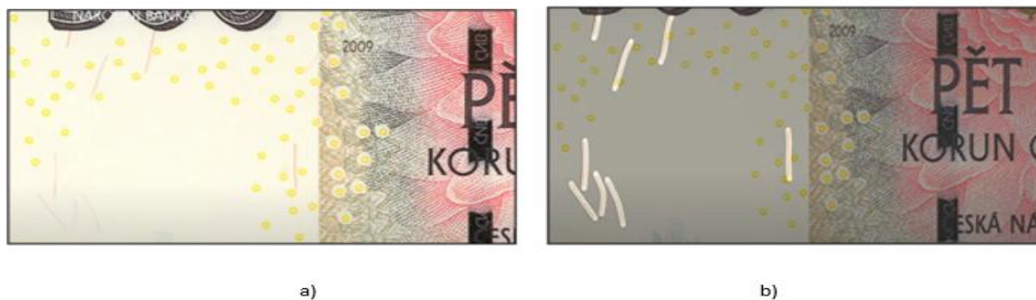
Obrázek 12 Zobrazení viditelných vláken a vláken pod UV světlem
