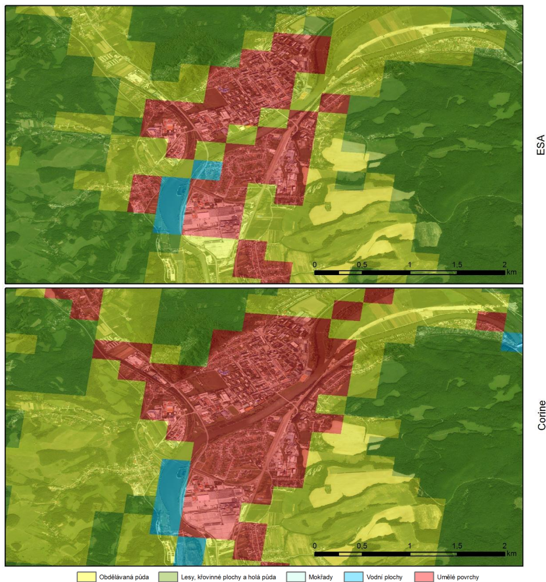
Obr. č. 12: Srovnání datových sad ESA a CORINE ve 300 m a měřítku 1:50 000.
