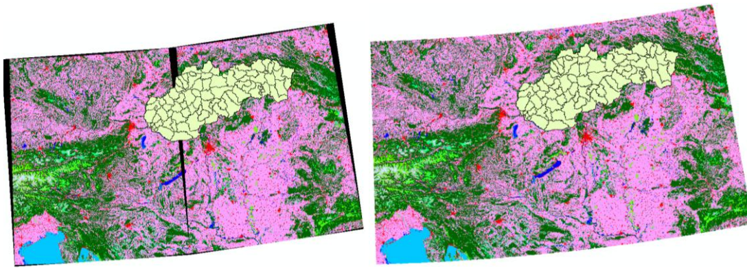
Obr. č. 7: Tvorba mozaiky na podkladu Globeland30 Zdroj: Vlastní tvorba v prostředí ArcMap 10.4
