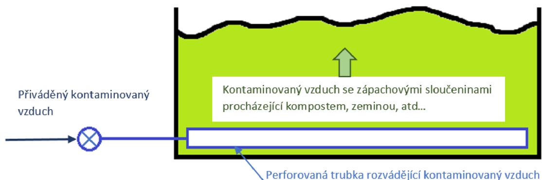
Obrázek 7 Schéma jednoduchého biologického filtru [26]
