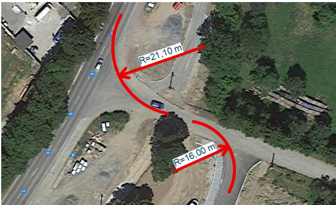
Obrázek 14 Vjezd na staveniště [24]
