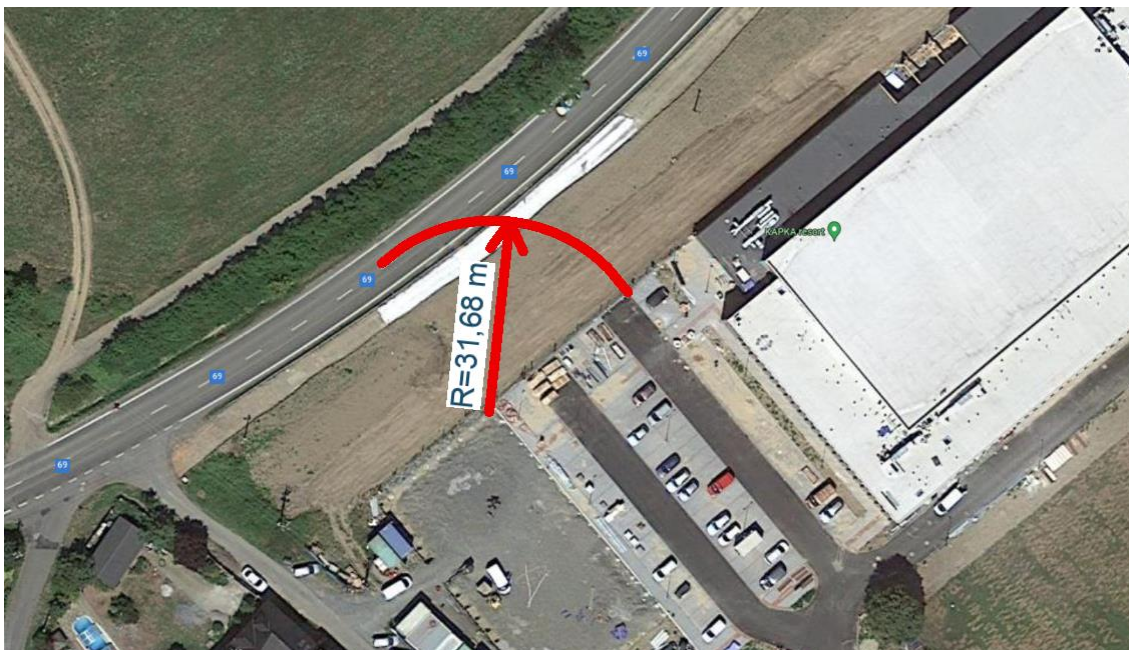
Obrázek 30 Vjezd na staveniště [46]
