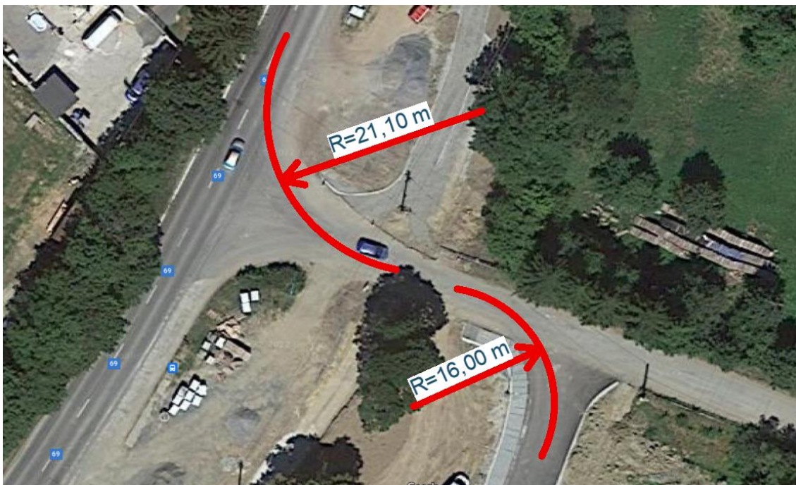
Obrázek 17 Vjezd na staveniště [28]
