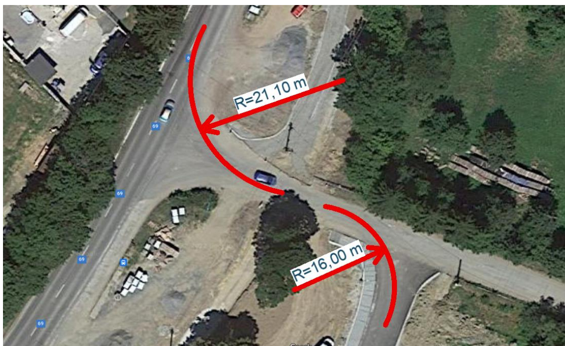
Obrázek 8 Vjezd na staveniště [17]
