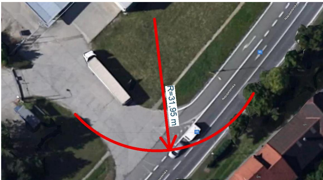
Obrázek 25 Výjezd z továrny prefa na silnici č. 55 v Otrokovicích [41]
