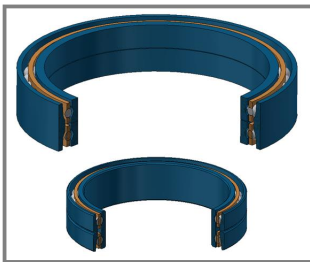
Obr. 21 Srovnání ložisek: nahoře staré, dole nové
