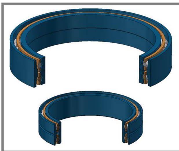
Obr. 21 Srovnání ložisek: nahoře staré, dole nové
