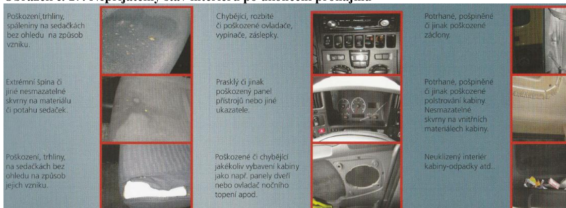
Obrázek č. 17: Nepřijatelný stav interiéru po ukončení pronájmu
