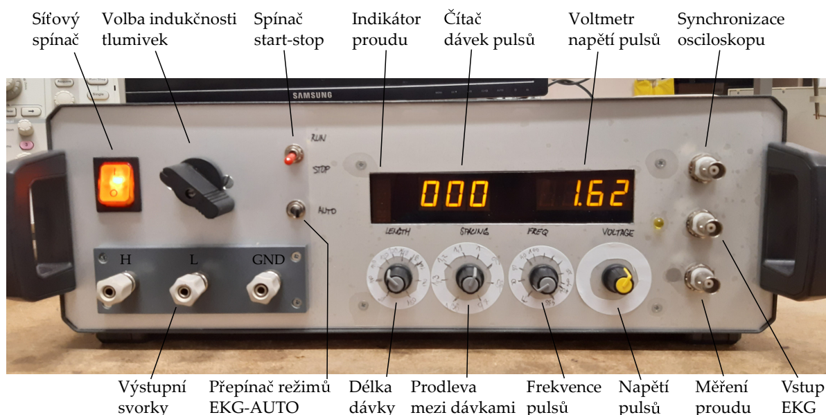
Obr. 5.1: Čelní panel generátoru.
