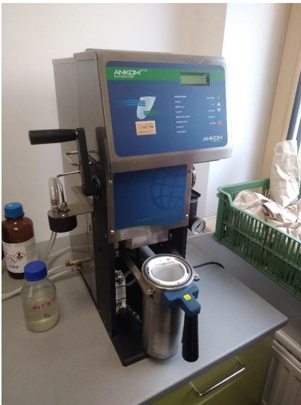
Foto č. 6: Přístroj Ankom, na kterém byl stanoven obsah tuku (autor: Petr Rothbauer)
