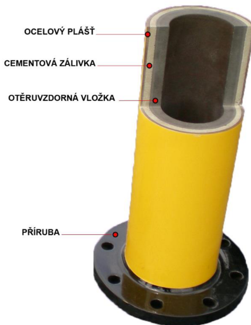
Obr. 11 Otěruvzdorné potrubí v řezu [11]
