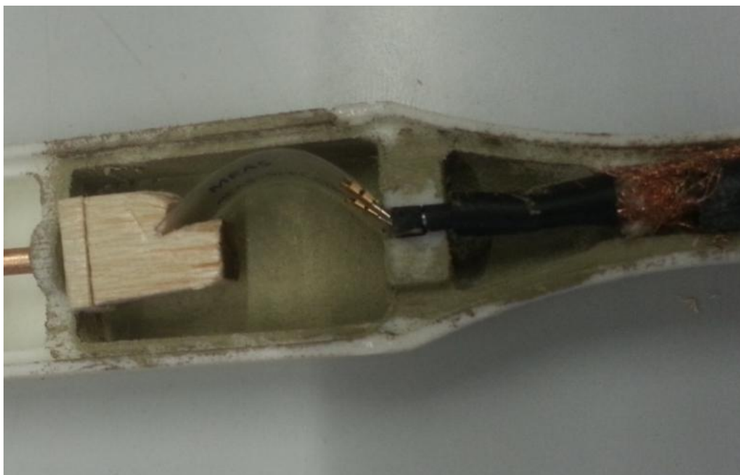
Obr. 4.2-4 Uchycení piezoelektrické fólie
