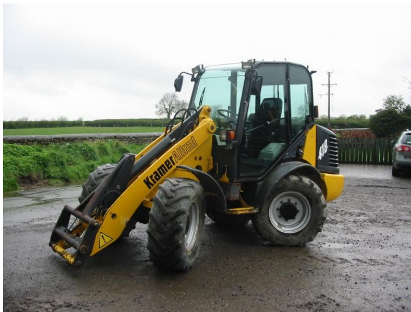
Obr.7 Řízení všech kol u nakladače Kramer Allrad 418[25]
