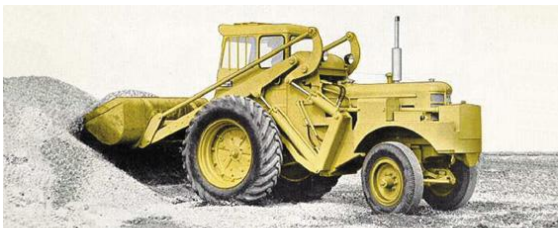
Obr.6 Nápravové řízení Volvo LM 222 rok výroby 1962[24]
