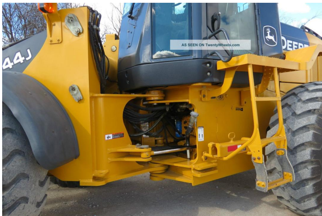
Obr.4 Kloubový rám nakladače John Deere 444J[23]
