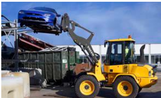
Obr.12 Kinematika TP výložníku u nakladače Volvo L35G [8]
