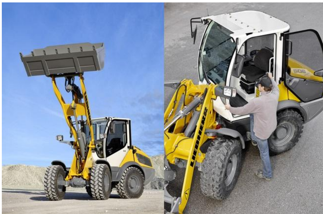
Obr.14 Kónická konstrukce výložníku nakladače L 508 compact [30]
