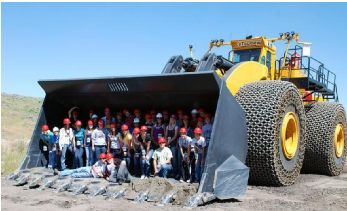
obr.1 Nakladač LeTourneau L-2350 s provozní hmotností 260 tun [20]
