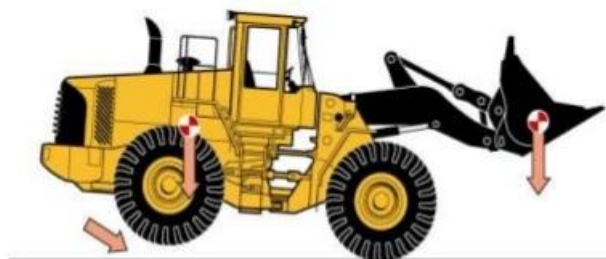
Obr.17 Překlopné zatížení nakladače v přímém směru [33]
