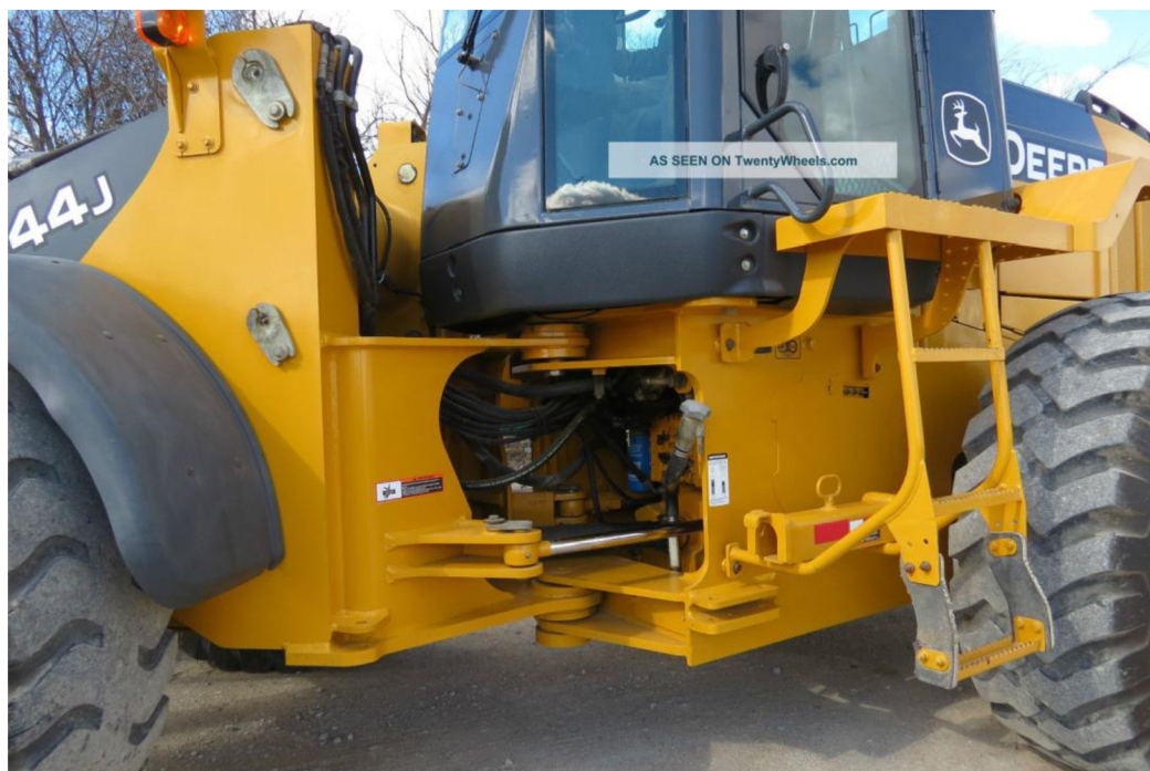
Obr.4 Kloubový rám nakladače John Deere 444J[23]
