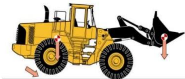
Obr.17 Překlopné zatížení nakladače v přímém směru [33]
