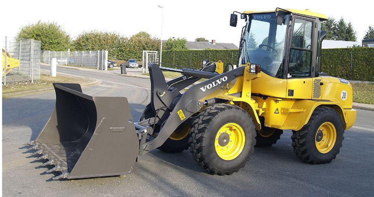
Obr.13 Volvo L35G se standardní lopatou a „Z“ kinematikou [29]
