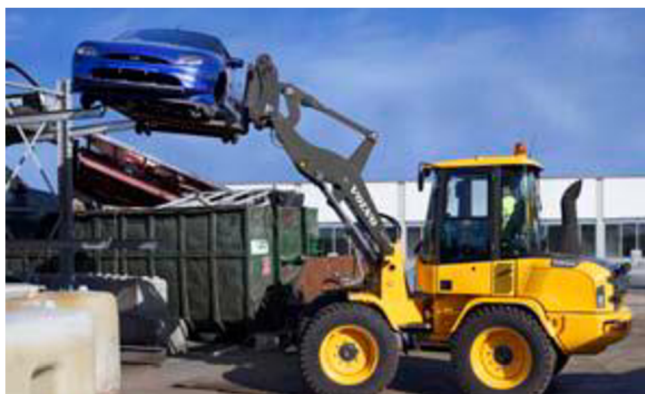
Obr.12 Kinematika TP výložníku u nakladače Volvo L35G [8]
