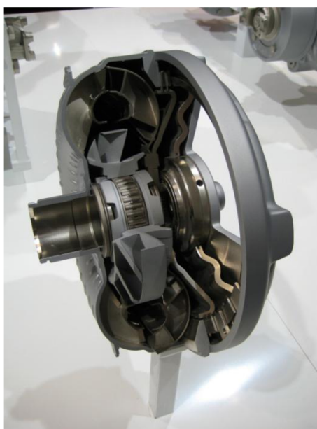
Obr.3 Řez hydrodynamickým měničem[22]
