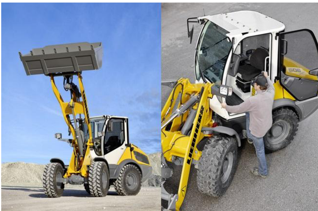
Obr.14 Kónická konstrukce výložníku nakladače L 508 compact [30]
