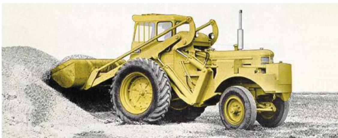
Obr.6 Nápravové řízení Volvo LM 222 rok výroby 1962[24]
