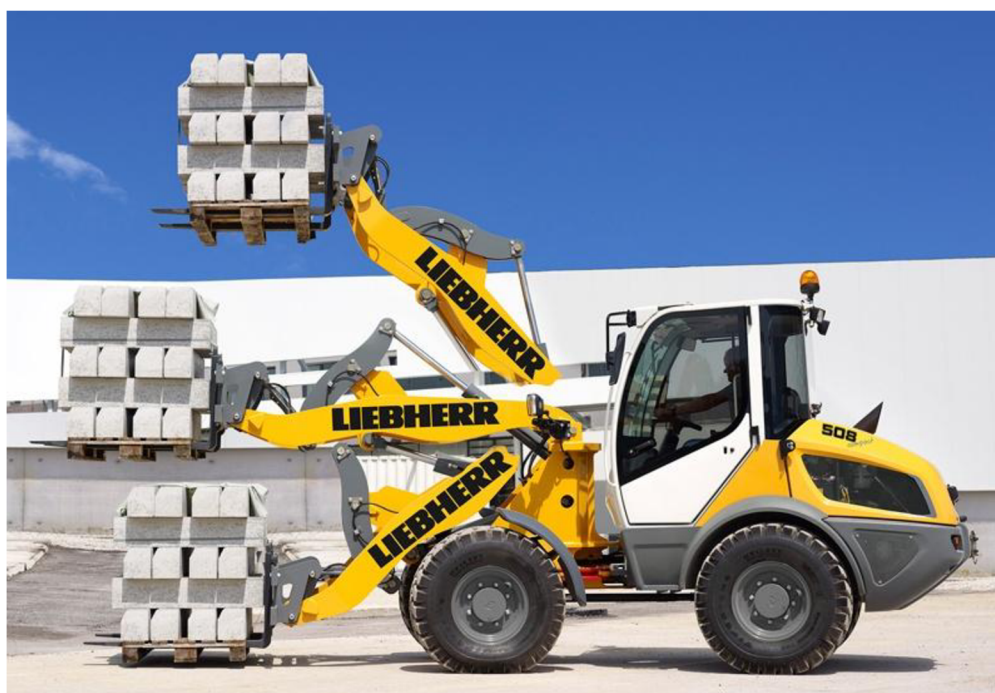
Obr.15 „Z“ kinematika s paralelním vedením při použití paletizačních vidlí [3]
