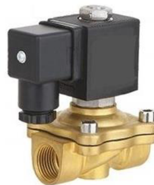
Obr. 30 Elektromagnetický ventil 0-10 bar G1/8 230 V NC F.S.A [29]
