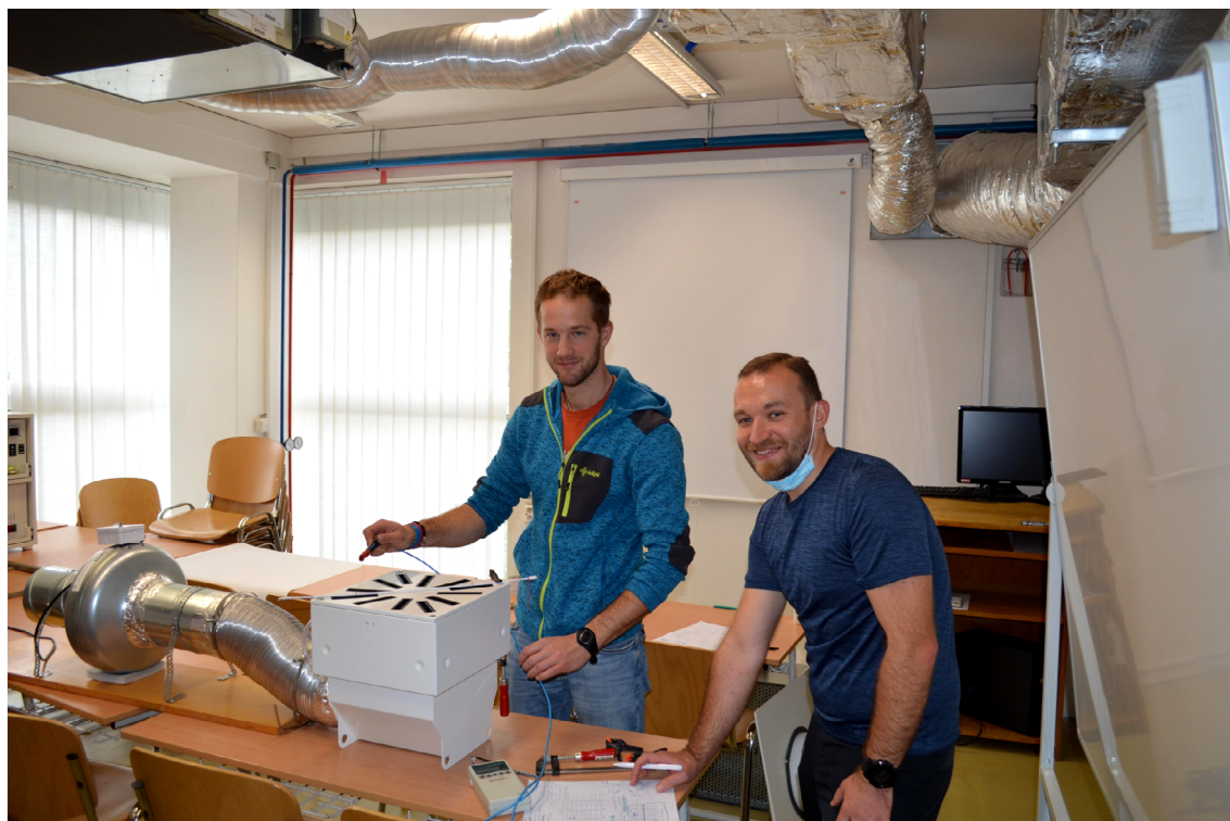
Obrázek 2.19 Měření rychlosti proudění vzduchu z vyústky
