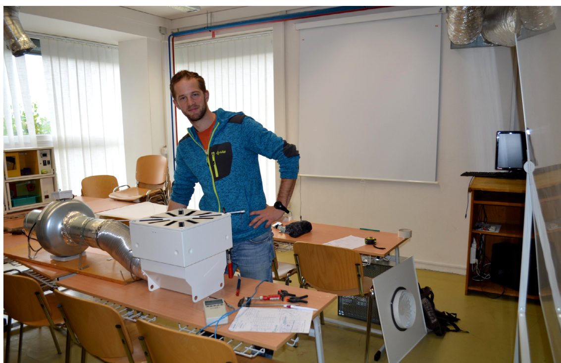
Obrázek 2.20 Měření směru proudu vzduchu z vyústky
