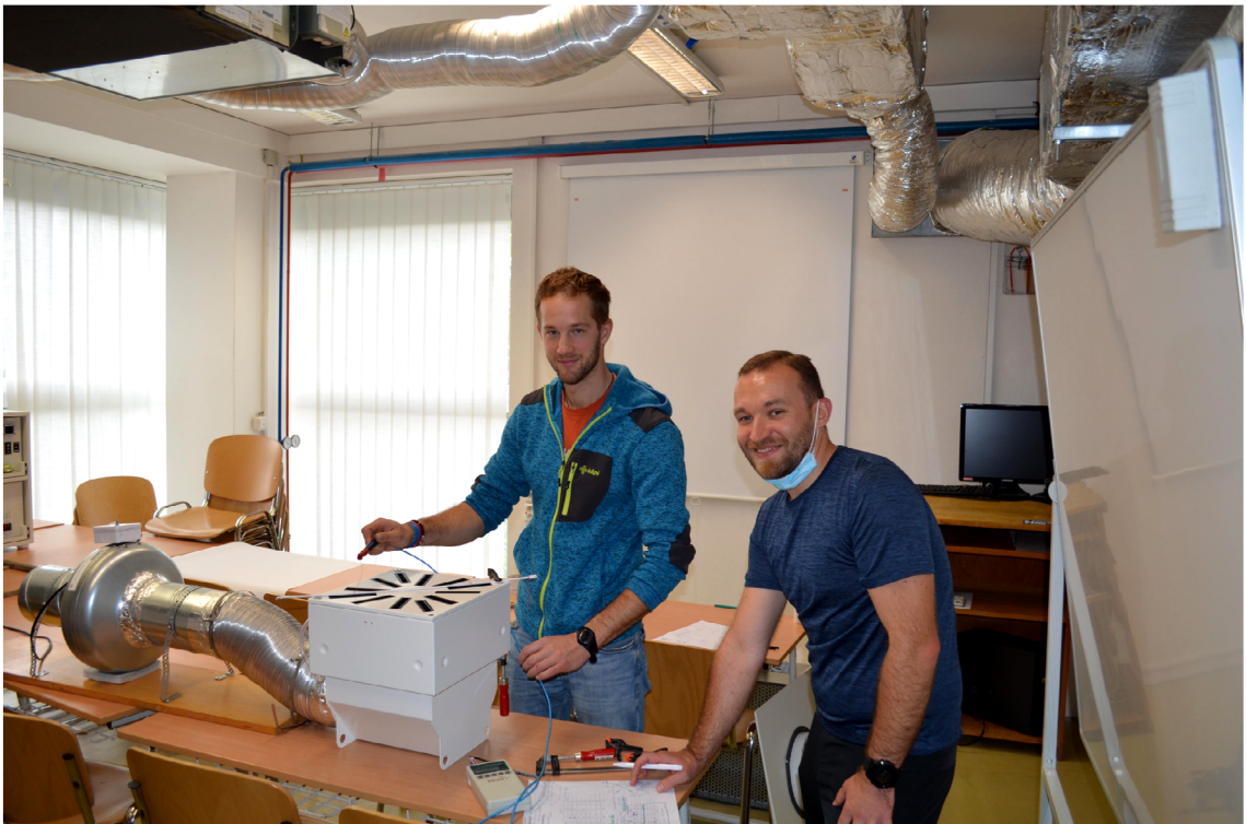
Obrázek 2.19 Měření rychlosti proudění vzduchu z vyústky
