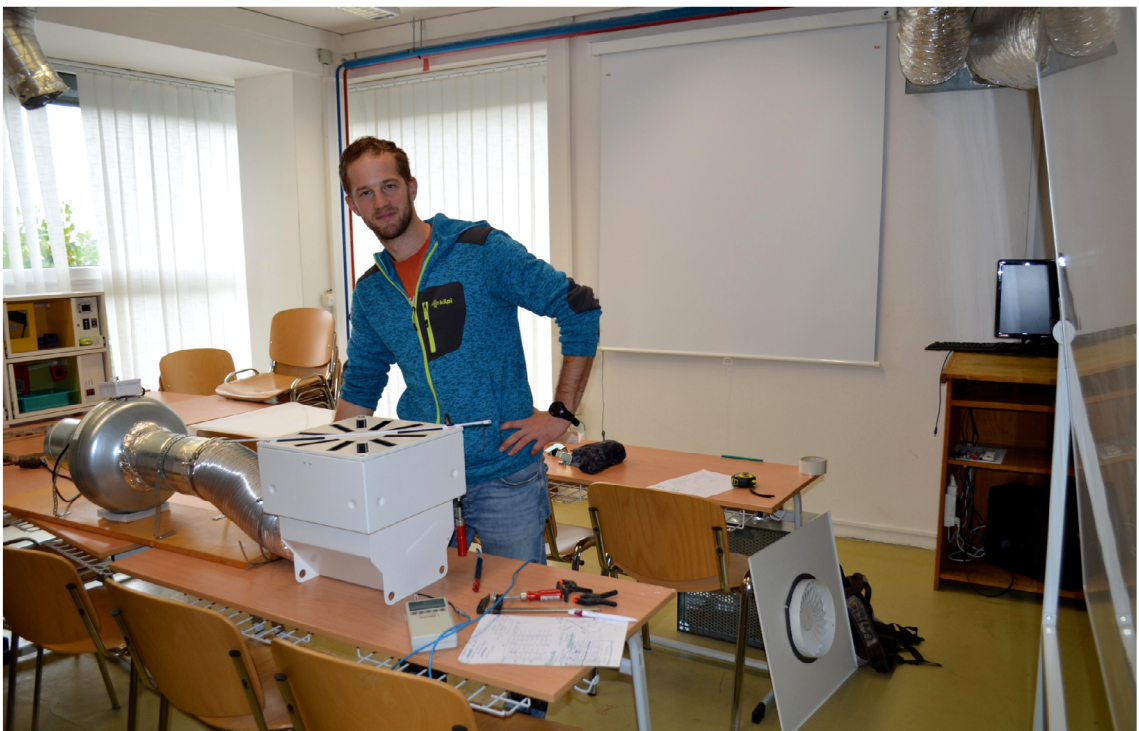
Obrázek 2.20 Měření směru proudu vzduchu z vyústky
