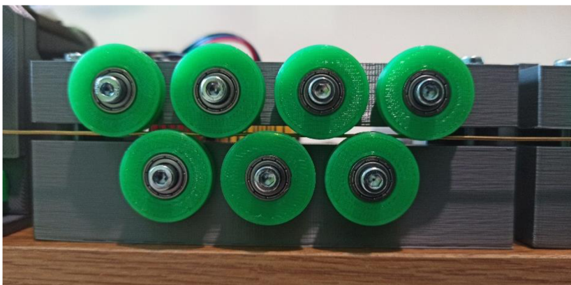
Obrázek 29 - Rovnaní drátu. Zdroj: Autor
