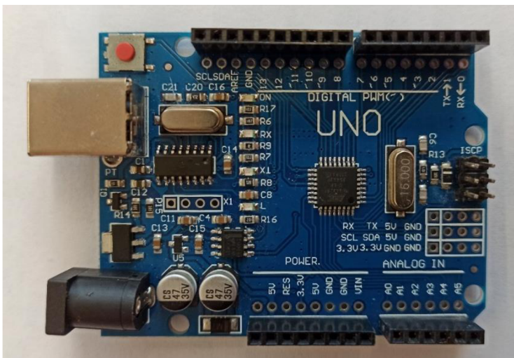
Obrázek 20 - Klon Arduina UNO, Zdroj: Autor
