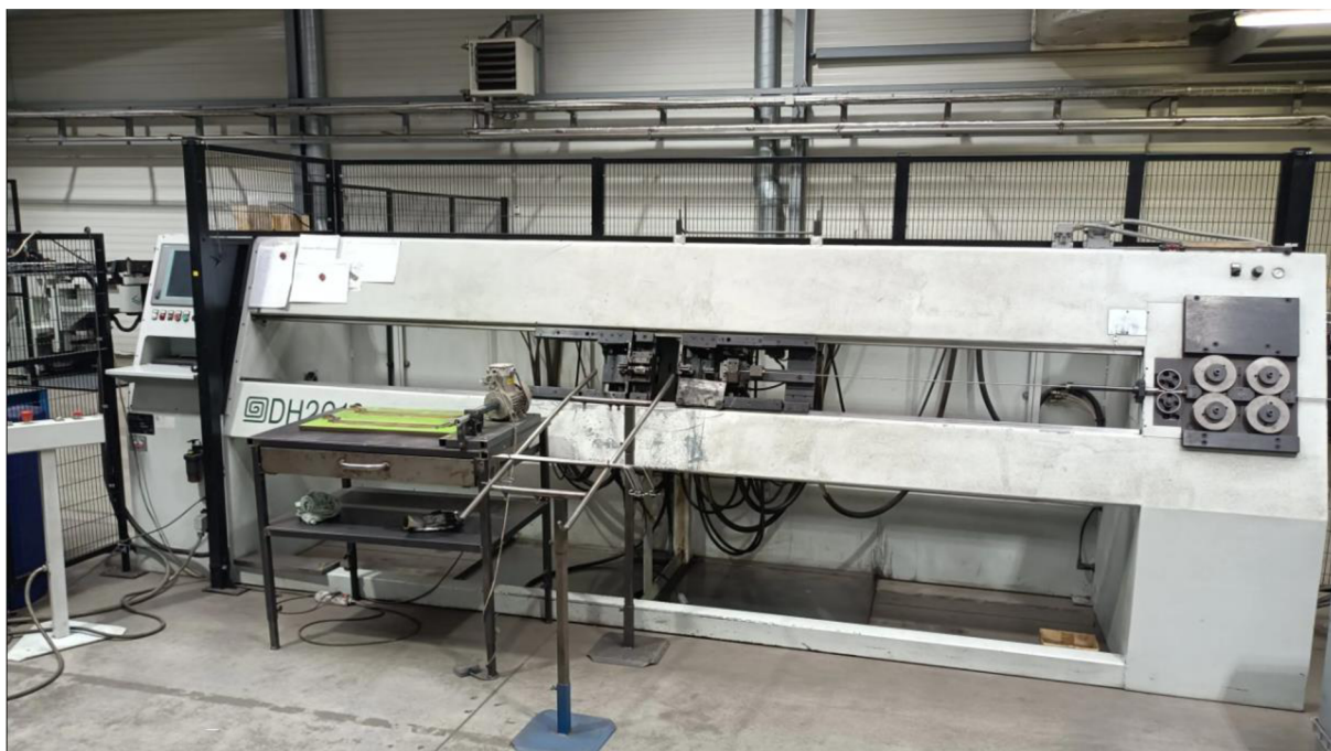
Obrázek 18 - Ohýbačka BLM DH2010. Zdroj: KovoSýkora, 2023
