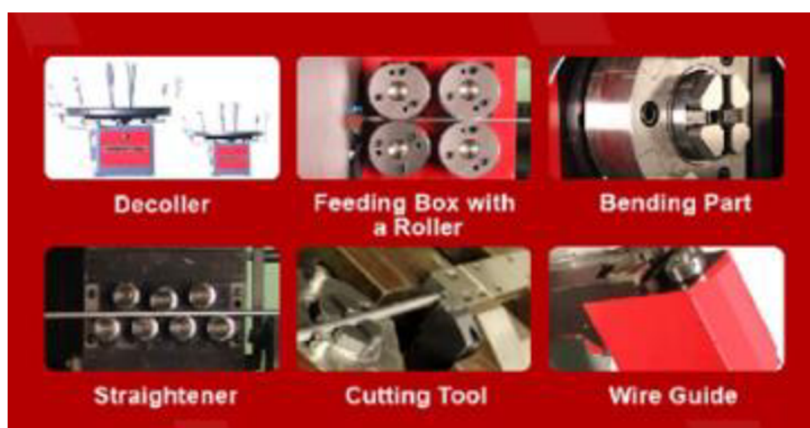
Obrázek 12 - Části CNC ohýbačky drátu. Zdroj: AutoLink, 2023
