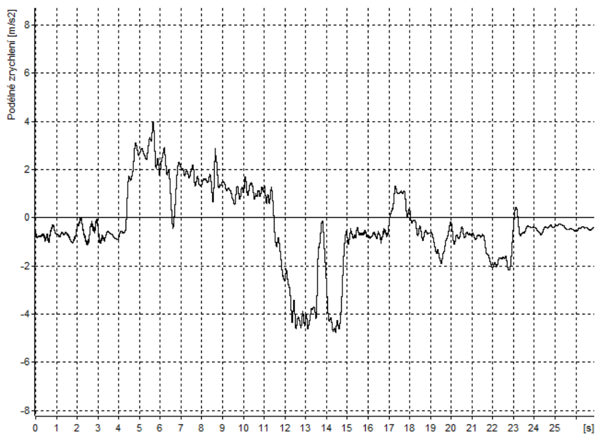
Graf č. 7.48 - Graf zpomalení při brzdění zadní brzdou na motocyklu Jawa 250 s přípojným vozíkem Pav 40
