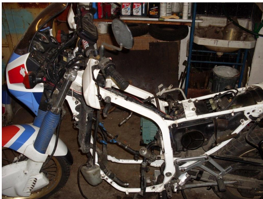
Obr. č. 2.21 - Uzavřený rám motocyklu Honda Africa Twin [autor]
