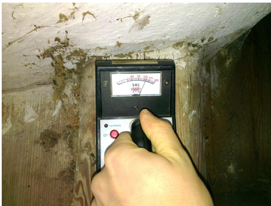
Obr. 28 Měření vlhkosti přístrojem Wagener L601-3
