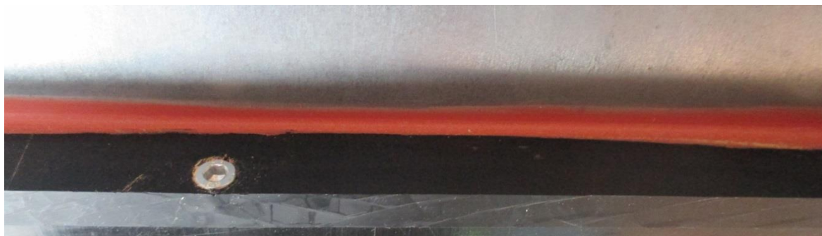
Obr. 3.8 Zatmelení rohu mezi podstavcem a vnějším pláštěm.
