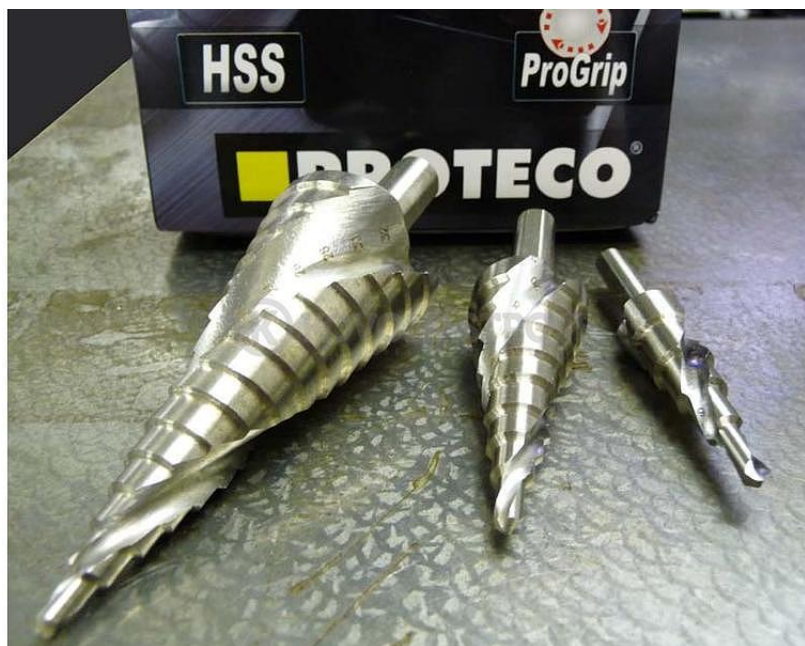
Obr. 3.1 Stupňovitý vrták do plechu 4 - 32 mm (vlevo) 47 .
