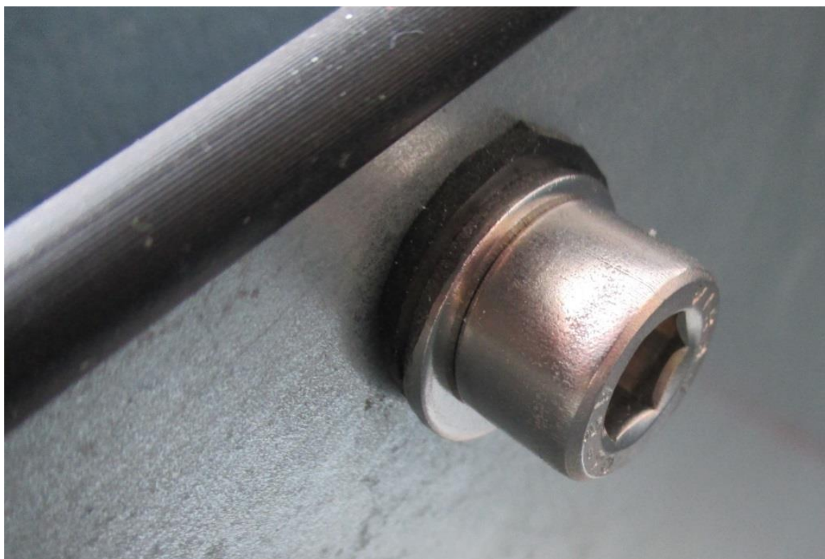
Obr. 2.5 Šroubový spoj s těsnící podložkou.
