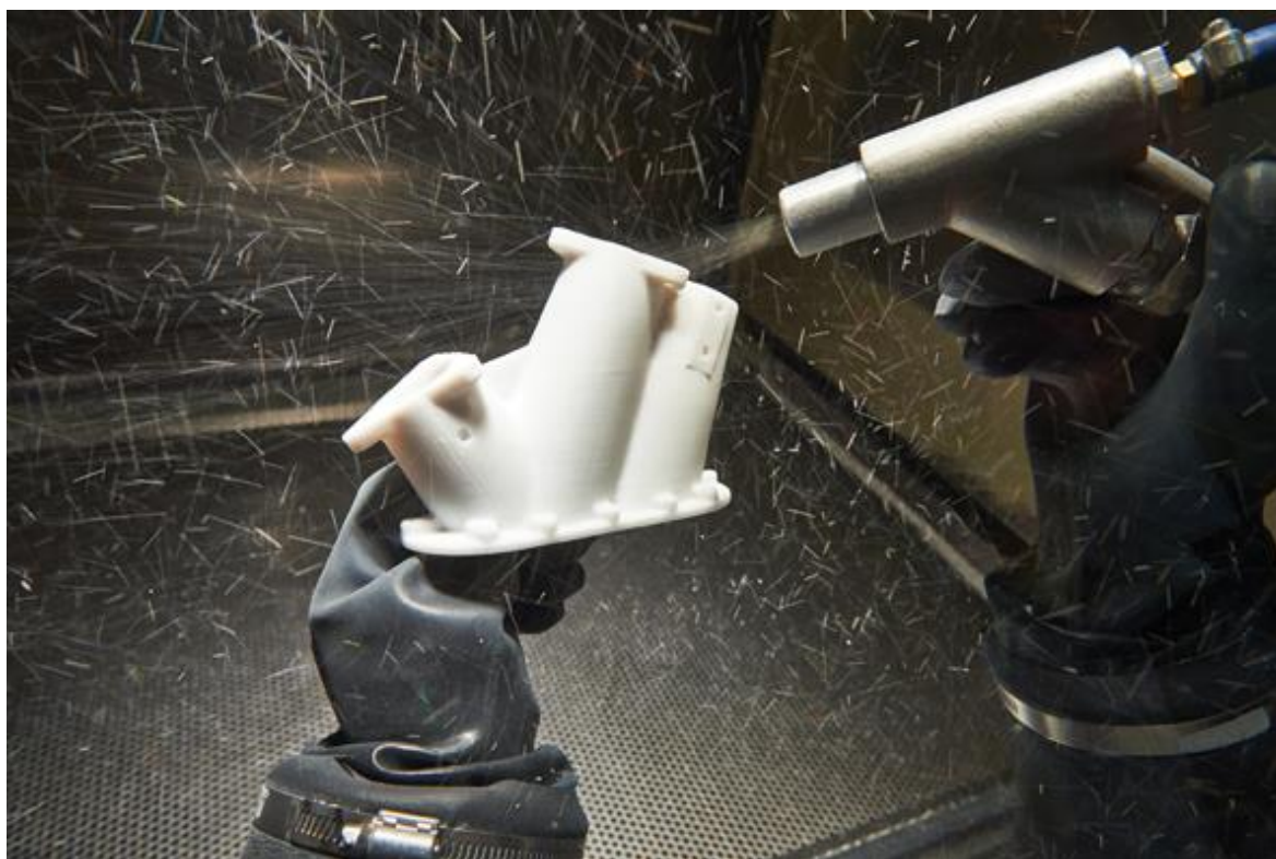
Obr. 1.5 Tryskání tištěné součásti broky 30 .
