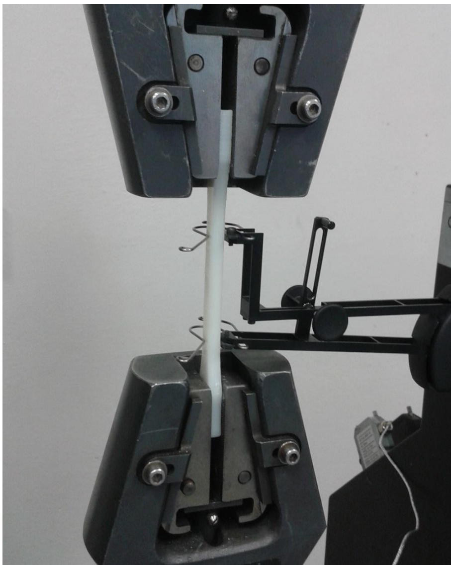
Obr. 5.5 Upnutí zkušební vzorku do samosvorných čelistí.
