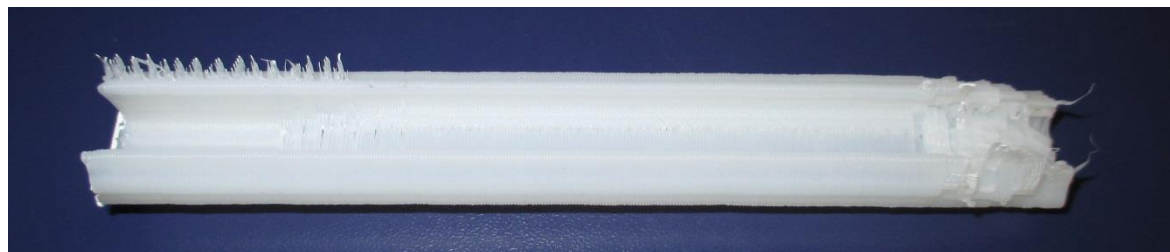
Obr. 4.1 Podpora zkušebního tělesa pro tahovou zkoušku.
