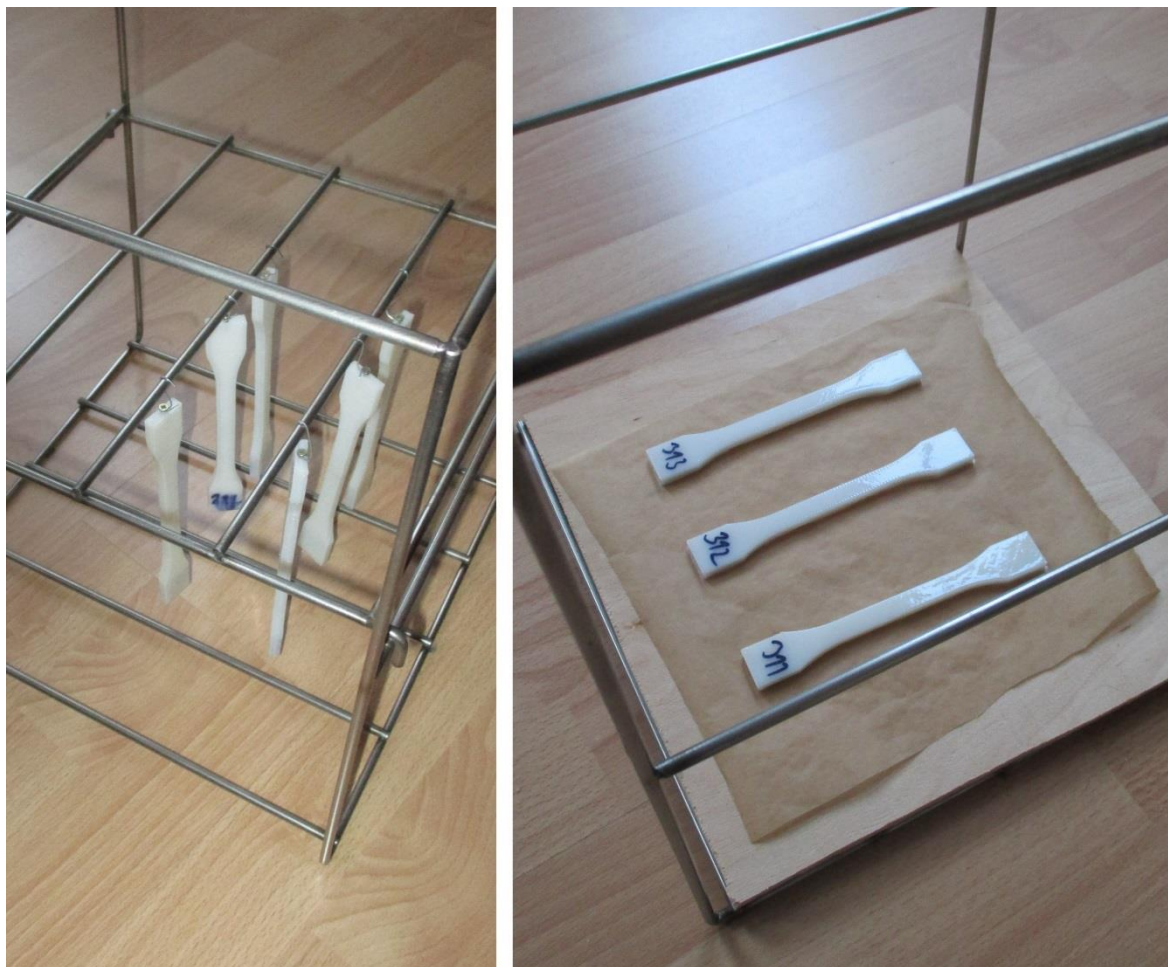
Obr. 5.4 Umístění vzorků na nosiči součástek (vlevo: vzorky tištěné na výšku, vpravo: vzorky tištěné na ležato)
