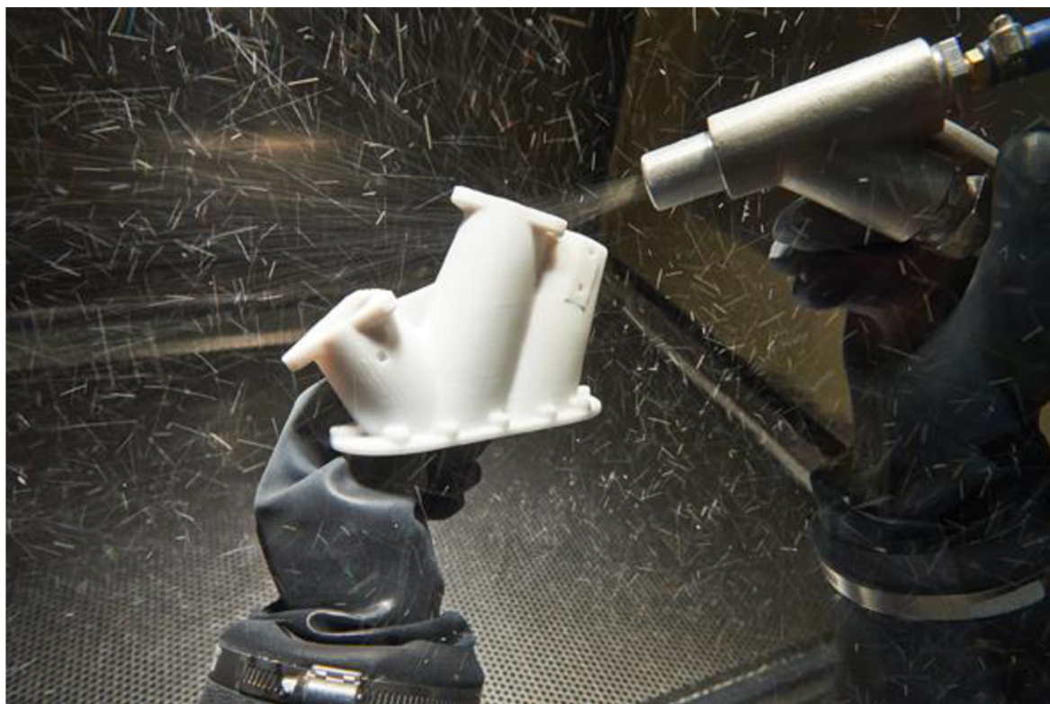
Obr. 1.5 Tryskání tištěné součásti broky 30 .
