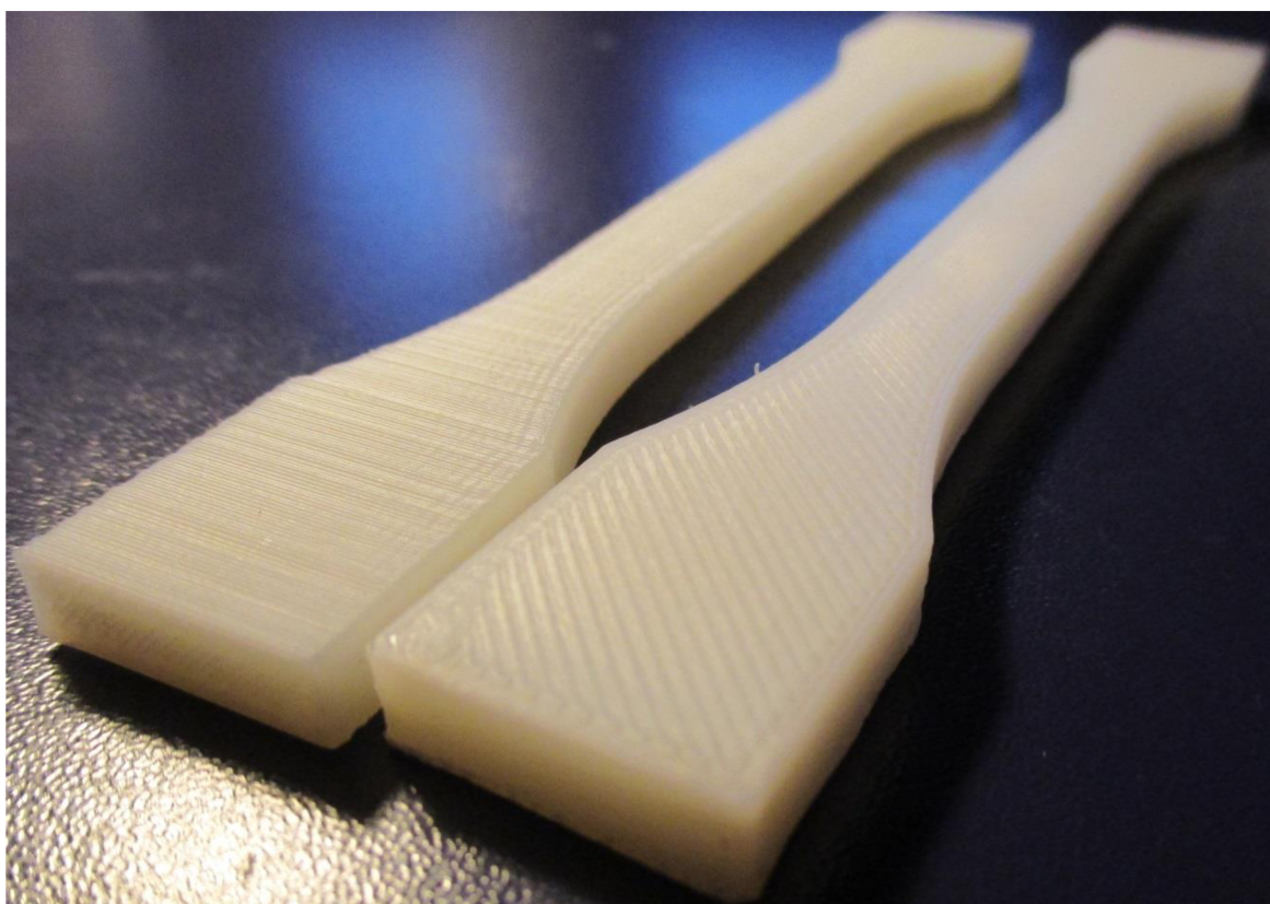
Obr. 5.3 Upravené vzorky po tisku (vlevo typ 2, vpravo typ 3).
