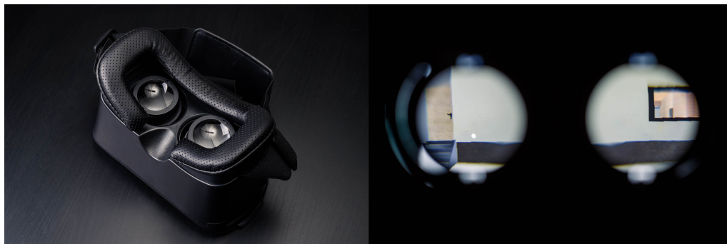
Obrázek 12: Čočky jsou z hlediska kvality VR nejdůležitějším prvkem brýlí a zpravidla jsou rovněž nejdražší položkou celého setu
