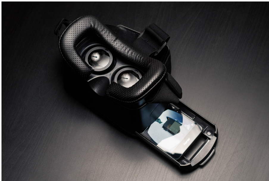
Obrázek 10: Lepší typy brýlí pro mobilní VR často obsahují různé zásuvné šuplíky pro umístění telefonu, aby byla dodržena ideální vzdálenosti od čoček brýlí
