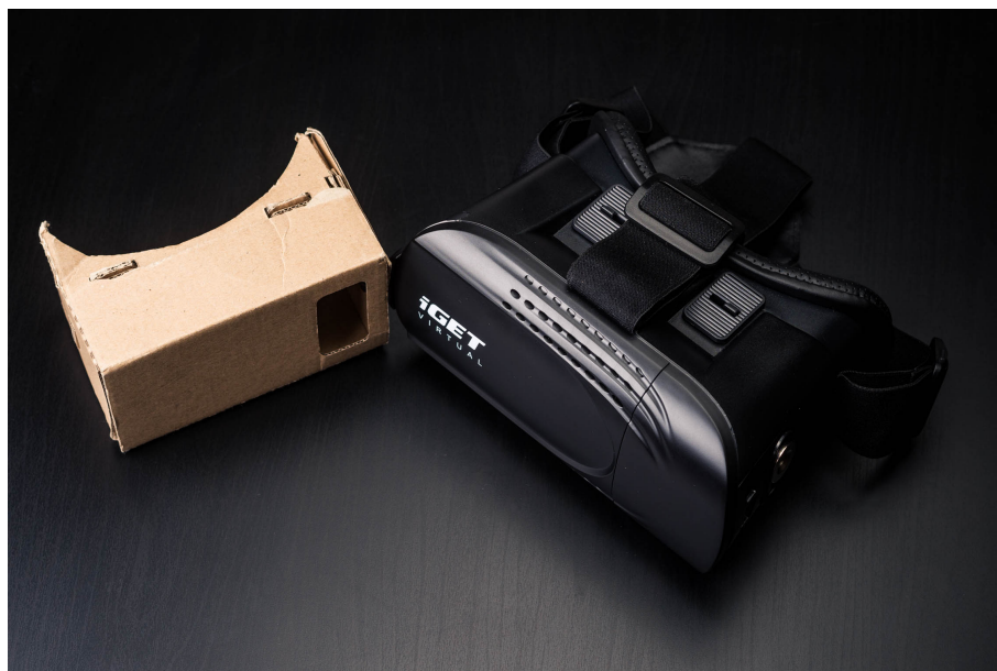
Obrázek 9: Brýle z kartonu s pořizovací cenou 120 Kč (nalevo) a kvalitnější brýle iGET Virtual R1 s pořizovací cenou 450 Kč, které umožňují mimo jiné i nastavením dioptrické korekce
