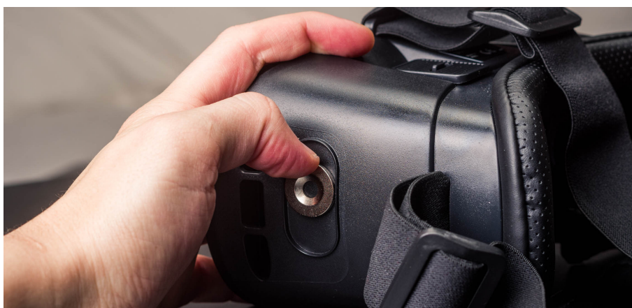
Obrázek 11: Posuvný magnet je zpravidla umístěn na některé straně brýlí a slouží pro potvrzení herních nabídek
