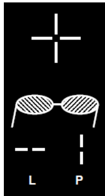
Obr. 13 Umiestnenie polarizačných skiel pri krížovom teste [36]
