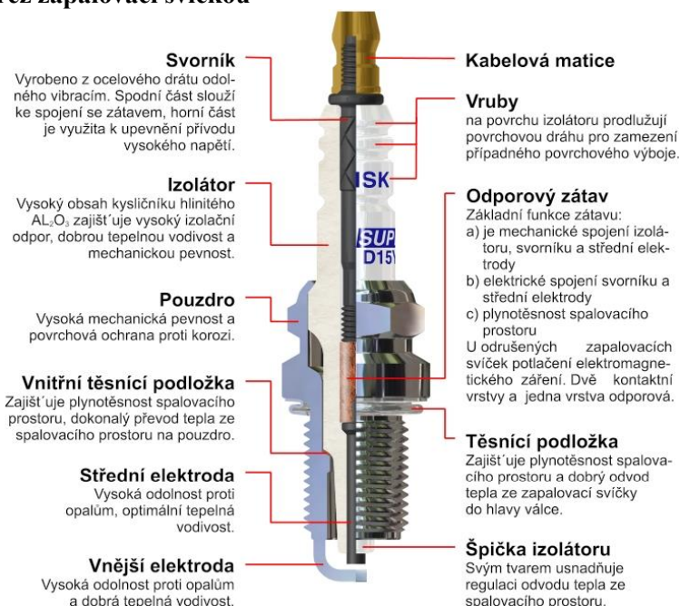
Obrázek 4 Průřez zapalovací svíčkou
